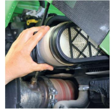
**+** Für Wartungs- und Reparaturarbeiten ist der Motor gut erreichbar. Die Haube klappt einteilig und weit nach oben; das Aggregat selbst ist nicht zu sehr durch Leitungen verbaut.
