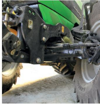
**+** 52 Grad maximaler Lenkeinschlag und ein Nachlaufwinkel von sechs Grad machen den 6160 wendig. Der Fahrkomfort mit der gefederten Vorderachse mit Niveauregulierung ist sehr gut.
