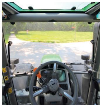
**+** Die Kabine wirkt hell und freundlich. Unterstützt wird dieser Eindruck durch das großzügig dimensionierte Dachfenster (Serie), das sich vor allem bei Frontladerarbeiten auszahlt.
