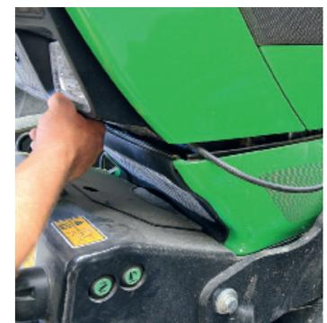
**-** Das Halteband für die Motorhaube verheddert sich beim Aufklappen. Beim Zuklappen behindert es dann das Schließen. AdBlue kann nur von rechts befüllt werden.
