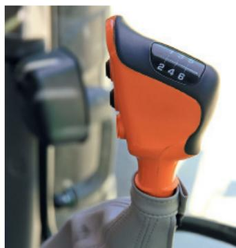
**-** Die Gangkulis des Schalthebels lässt nach wie vor kein schnelles Schalten zu und ist etwas hakelig. Lob gibt es hingegen für die butterweich schaltenden Lastschaltstufen.
