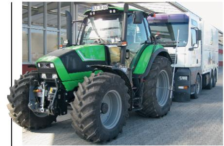
**Klassenprimus:** Der 6160 P liefert bei allen Arbeiten sehr gute Verbrauchswerte ab und ist mit 272 g/kWh PowerMix-Durchschnitt aktuell der sparsamste bei der DLG gemessene Traktor seiner Klasse. Besonders sparsam arbeitet der Sechszylinder bei schweren Arbeiten. Zusätzlich zum Diesel verbraucht der 6160 P beim Arbeiten AdBlue-Lösung, um seine Abgase entsprechend der Tier-4i-Norm zu reinigen. Der durchschnittliche AdBlue-Verbrauch beträgt gute 23,1 g/kWh (6,3 Prozent des Dieserverbrauchs).
