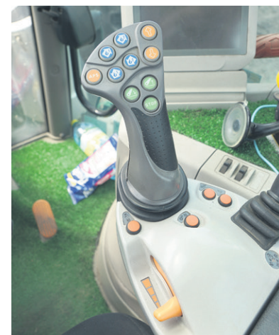
Traktor Agrottron 6160 CShift ma miękką oś, kabinę na sprężynach, przedni TUZ, mocniejszą pompę hydrauliczną typu Load Sensing o wydajności 160 l/min oraz 24-biegową skrzynię, w której wszystkie przełożenia są zmieniane joystickiem
