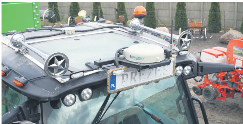
Wykorzystując nawigację satelitarną TTV-ka jest prowadzona po polu z dokładnością do 1–2 centymetrów
