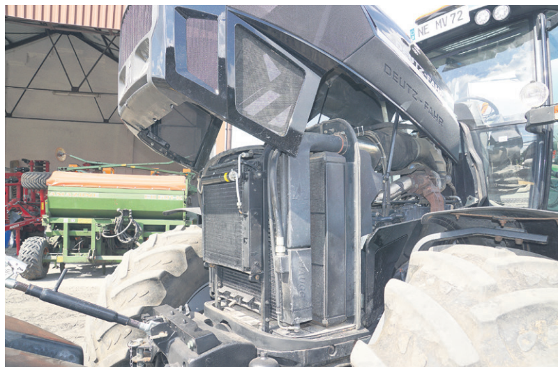
Po modyfikacji silnik Deutz-Fahra Agrottrona X720 ma 7,8 litra pojemności
