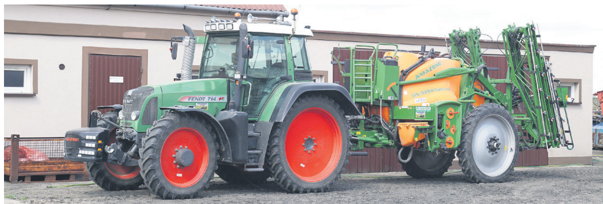
Fendt 714 Vario to traktor z 2008 roku. Ma przepracowanych 4000 motogodzin, a jego głównym zadaniem jest współpraca z opryskiwaczem zaczepianym Amazone UX 3200 Special
