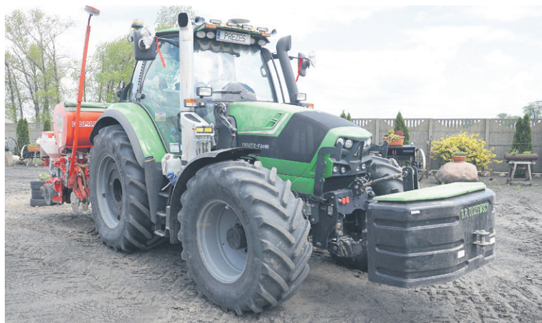
Traktor Agrottron 6160 CShift ma miękką oś, kabinę na sprężynach, przedni TUZ, mocniejszą pompę hydrauliczną typu Load Sensing o wydajności 160 l/min oraz 24-biegową skrzynię, w której wszystkie przełożenia są zmieniane joystickiem
