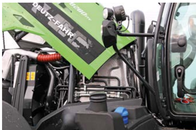
Pomiędzy kabiną i komorą silnika widać wyraźną przerwę. Dzięki niej do operatora dociera mniej hałasu i wibracji. Wolne miejsce wykorzystano do montażu mechanizmu wycieraczki przedniej szyby.
