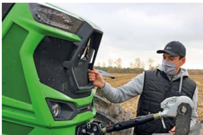
Jarostaw Figurski z SDF Polska prezentuje uchwyty, które ułatwiają otwieranie maski ciągnika. Niby niewielkie udogodnienie, ale po prostu pomocne i w dodatku ładnie wpisane w design ciągnika.
