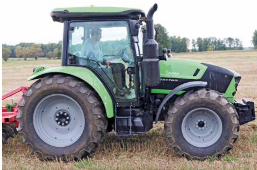
Rozstaw osi ciągnika z silnikiem 4-cylindrowym Deutz-Fahr serii 5 Stage V wynosi 2400 mm.
