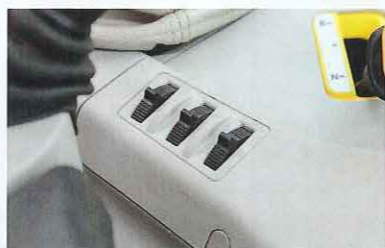
Grazil: Die kleinen (nur mit Aufkleber an der Scheibe beschrifteten) Dreher in der Konsole für bis zu drei Ventile.
