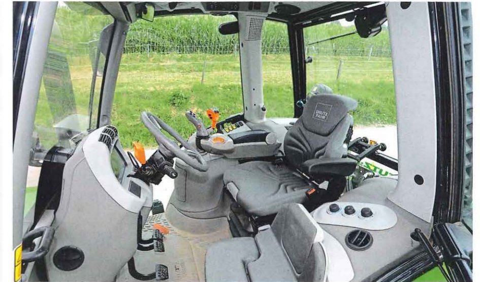
Trotz der sechs Pfosten ist die Sicht gut. Trotzdem sollte die Kabine in etlichen Details überarbeitet werden. Auch eine Geräuschbelastung von 76,6 dB(A) ist kein Spitzenwert. Fotos: Tovornik, Praktiker
