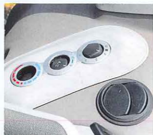
Eingedrückt: Es gibt nur vier Gebläsestufen und keine Klimaautomatik. Außerdem drücken sich die neuen Knöpfe immer wieder ein.
