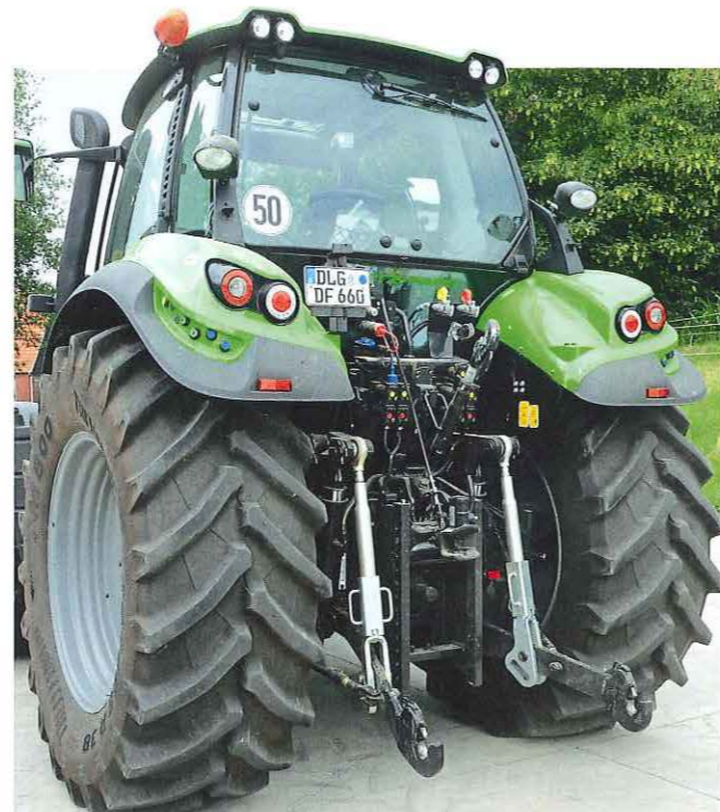
Die Hubkraft reicht immer. Die Ölschlüsse könnten aber besser beschriftet sein und auch hinten wünschen wir uns Walterscheid-Kuppler.
