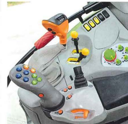
Hat man sich an die schräg gestellte Schaltkulisse gewöhnt, ist der neue Hebel okay. Die Schaltwege bleiben aber lang, und der Multifunktionsgriff ist vielen Fahrern zu klobig.
