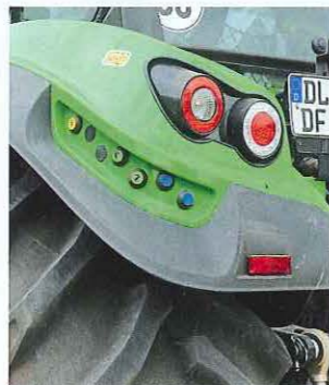
Komplett: Links wie rechts gibt es eine externe Bedienung für Hubwerk, Hydraulik und Zapfwelle.
