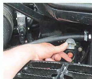
Sicher: Der Batterie-Hauptschalter schützt vor stillen Verbrauchern.
