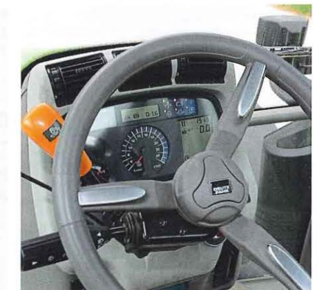
Die Wendeschaltung links kann nicht im Wechsel mit den Tastern rechts genutzt werden. Der SCR-Kat rechts vor der Scheibe stört die Sicht im Alltag wenig.
