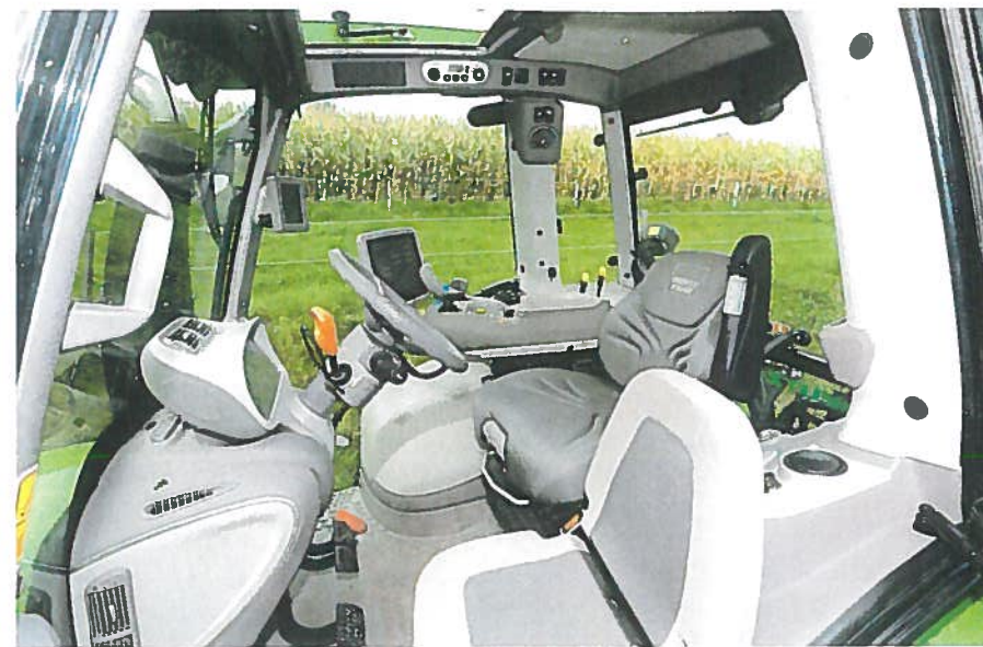
Fast 76 dB(A) sind für eine neu entwickelte Kabine viel. Der helle Bezugsstoff ist außerdem schmutzempfindlich und könnte robuster sein. Leider kann man den Sitz mit Bedienarmlehne für eine bessere Sicht nach hinten nicht seitlich drehen.
