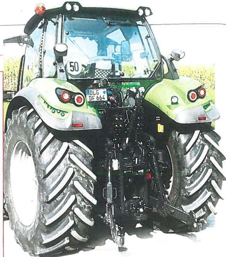
Die Hubkraft ist mit 7 t und mehr sehr gut! Auch die Anordnung der Elektrik über der Hydraulik ist durchdacht.
