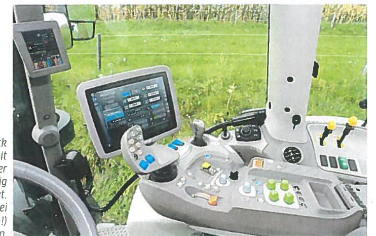
Das Armaturenbrett schwenkt zusammen mit dem Lenkrad. Die Arretierung sollte aber spielfrei sein.
