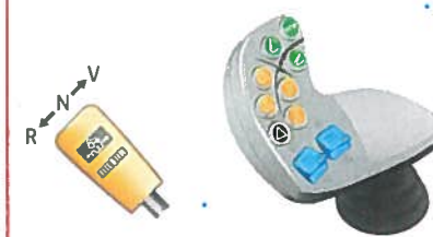
Der neue Joystick hat viele Knöpfe mit gleicher Form, aber verschiedenfarbig und unterleuchtet. Und man kann zwei (Proportional!) Ventile bedienen.
