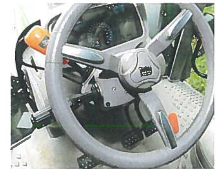
Das Armaturenbrett schwenkt zusammen mit dem Lenkrad. Die Arretierung sollte aber spielfrei sein.
