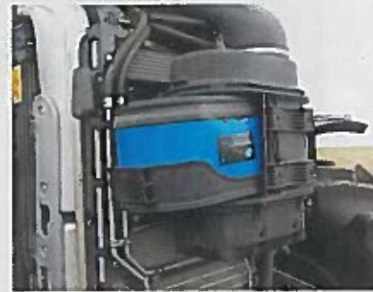
L'accessibilité au filtre à air moteur, positionné à l'avant du tracteur, s'avère aisée.
