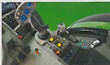
Le joystick principal gère la transmission ainsi que les distributeurs, et comporte des boutons programmables.
