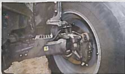
La transmission TTV et le freinage à disques secs sur le pont avant permettent au 8280 de rouler à 60 km/h (selon législation).
