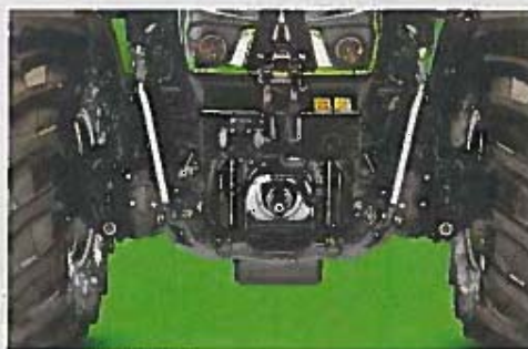
La prise de force avant, fournie en standard, tourne au régime de 1000 tr/min. L'optionnel relevage soulève 2880 kg.
