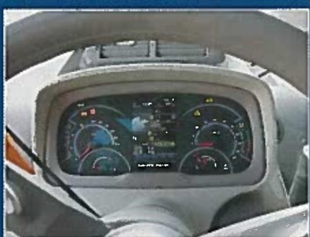
Un écran central intégré au tableau de bord apporte des informations sur le moteur, la transmission ou encore le régime de prise de force.
