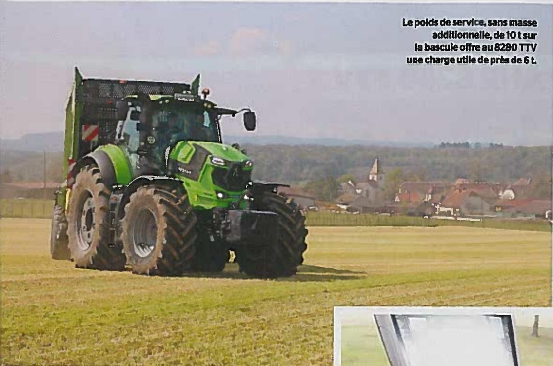
Le poids de service, sans masse additionnelle, de 10 t sur la bascule offre au 8280 TTV une charge utile de près de 6 t.
