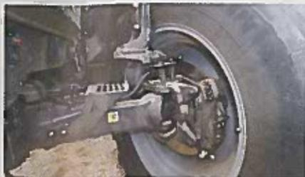
La transmission TTV et le freinage à disques secs sur le pont avant permettent au 8280 de rouler à 60 km/h (selon législation).
