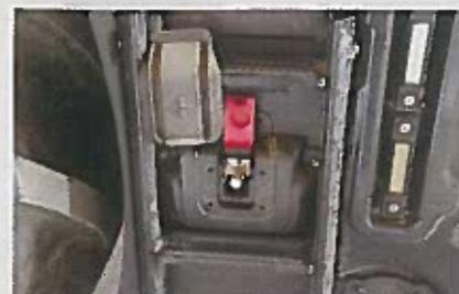
L'accès à la batterie s'effectue sur le côté droit du tracteur via une borne positive installée dans les marche-pieds.
