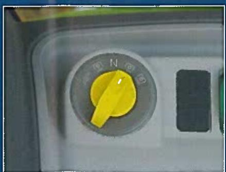
Le 8280 bénéficie d'un sélecteur de régime de prise de force électro-hydraulique, contre un système mécanique sur les Séries 6.
