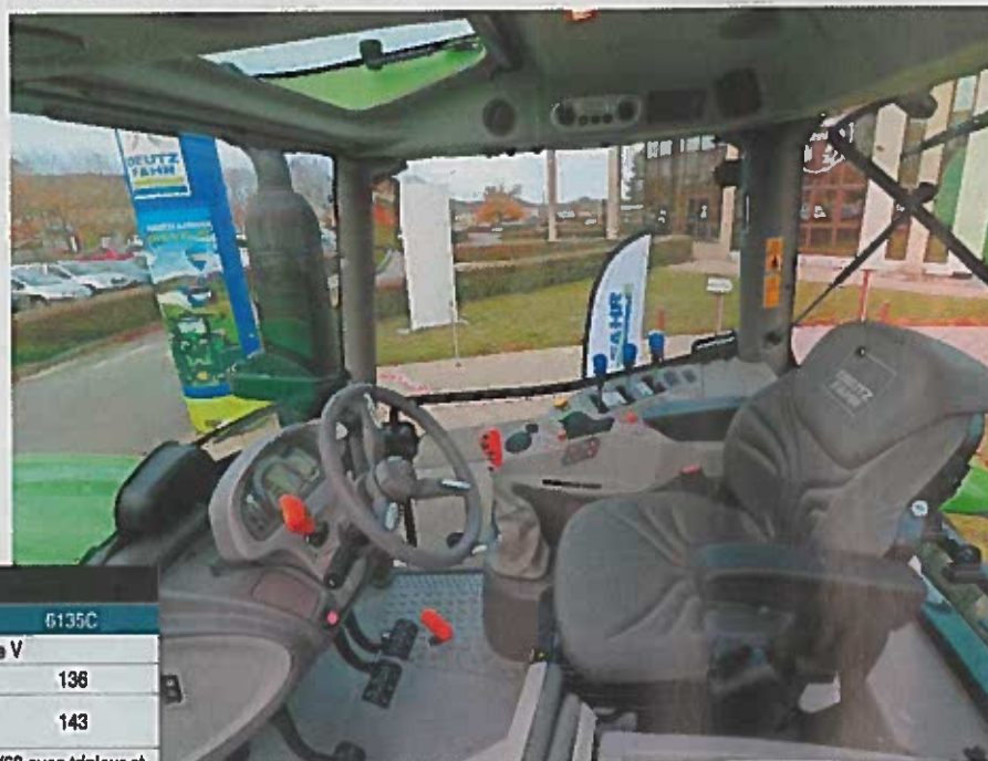
La cabine abrite un agencement différent selon le choix de transmission. Ici, la variante semi-powershift se caractérise par ses distributeurs hydrauliques mécaniques.
