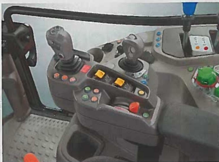
La transmission full-powershift de dernière génération nommée « RVshift » se contrôle à l'aide d'un joystick monté sur l'accoudoir multifonction.
