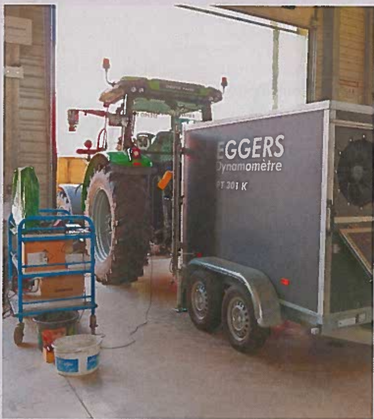
Le banc de puissance du lycée agricole de Saint-Yrieix-la-Perche (Haute-Vienne) a mis à l'épreuve notre Deutz-Fahr 6125C, qui a révélé une puissance maximale de 116,3 ch OCDE.
