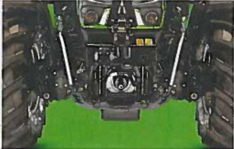
La prise de force avant, fournie en standard, tourne au régime de 1000 tr/min. L'optionnel relevage soulève 2880 kg.
