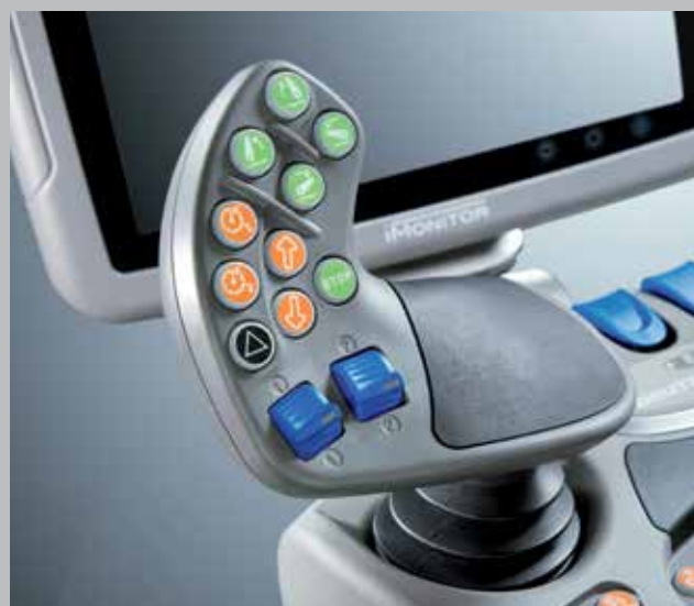
Avec une vitesse d'avancement maximale de 50 km/h (selon la loi en vigueur) la nouvelle série 6 TTV se révèle un véritable professionnel du transport. En appuyant simplement sur deux boutons de la poignée, le conducteur peut facilement rappeler 4 vitesses distinctes tant dans les champs que sur route et travailler de manière optimale à vitesse constante.
