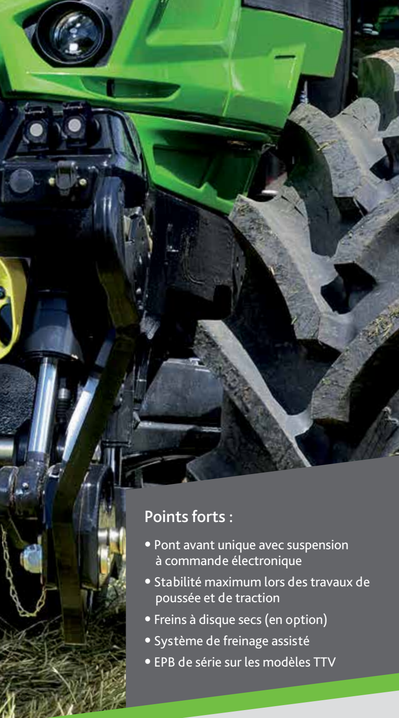
Suspension adaptative électronique à système anti-plongée et anti-cabrage. La suspension peut servir tant dans les champs que sur route. Entièrement verrouillable au besoin.
