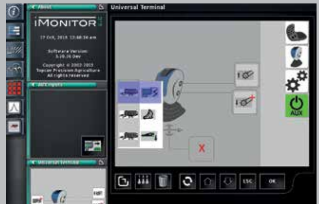
Prédisposition VT4. Fonctions d'outil commandées par les boutons du tracteur.
