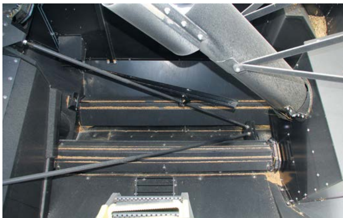
Na dnie zbiornika ziarna, którego pojemność wzrosła z 9500 do 10500 l pracują zamiast jednej dwie żmijki wygarniające.
