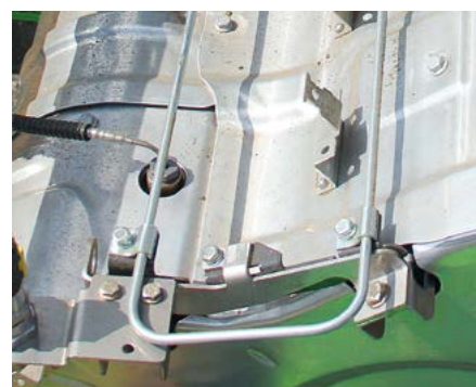
Wraz z normą czystości spalin Stage V nad obudową ekokomponentów zauważymy pierścieni dostarczający przez rozmieszczone co 4 cm otwory sprężone powietrze do cyklicznego zdmuchiwanie pyłu i plew.
