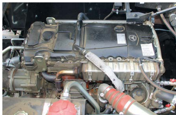
Deutz-Fahr C9306 TS ma sześciocylindrową jednostkę napędową ze stajni Mercedes-Benz o pojemności skokowej 7,7 l oraz mocy nominalnej 381 KM. To o 18 KM więcej od dotychczasowego flagowca.
