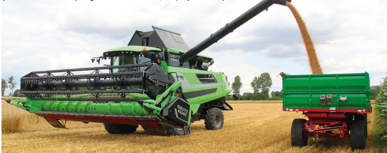
Maksymalne tempo opróżniania skrzyni nasiennej producent zwiększył do 120 l/s. Zmierzony przez nas czas rozładunku pełnego zbiornika ziarna to 95 s, co daje wydatek nieco ponad 110 l/s.
