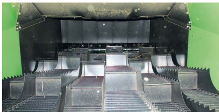
W kombajnach serii C9300 wytrząsacze są o 20 cm dłuższe od przedstawicieli ustępującej rodziny C9200.
