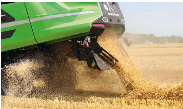
Odkładana na ściernisko słoma sypława teraz nie przed kadłubem sieczkarni stomy, a po obudowie deflektora sieczki.
