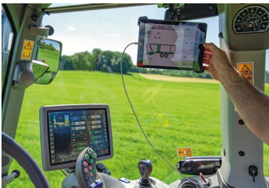
Bardzo ciekawym, obniżającym koszty zakupu rozwiązaniem jest dublujący niektóre funkcje komputera pokładowego dowolny tablet lub smartfon zamiast drugiego identycznego fabrycznego terminala.
