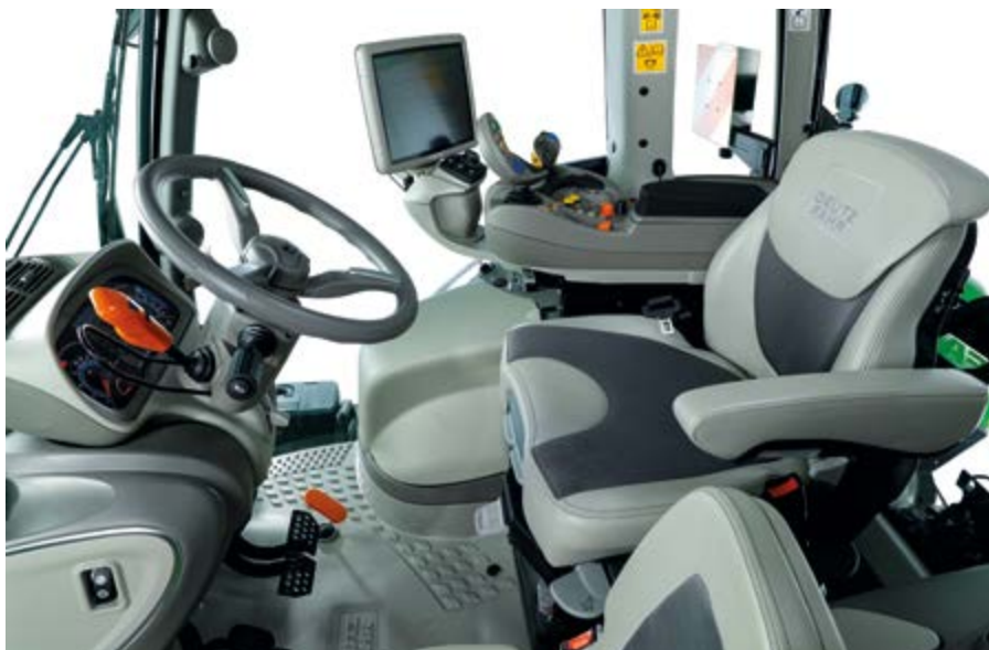
Wnętrze kabiny wygląda znajomo. Jest bowiem ono zunifikowane z obecnymi w ofercie seriami ciągników Deutz-Fahr. Różni się jednak nieznacznie, m.in. liczbą wlotów powietrza w układzie wentylacji oraz elementem do zmiany prędkości wałka WOM.
