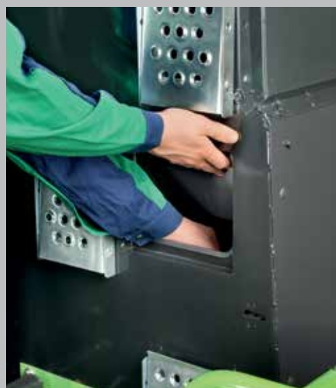
Salidas para recoger fácilmente las muestras.
