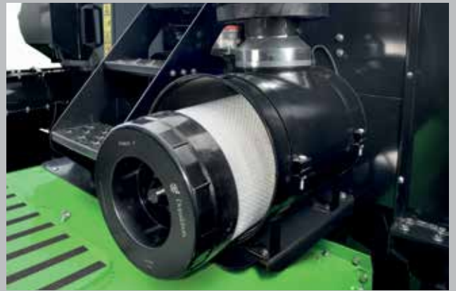
Se accede al cartucho del filtro sin necesidad de herramientas.
