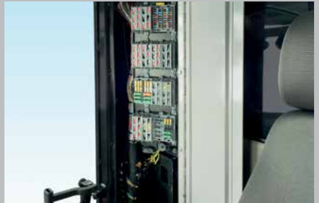
El panel de fusibles eléctrico.
