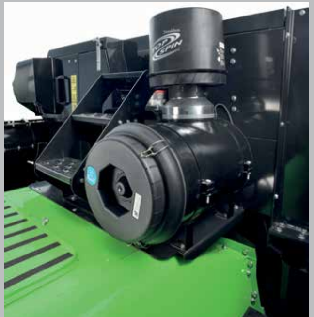
Filtro autolimpiante de altas prestaciones para trabajar bajo cualquier condición.
