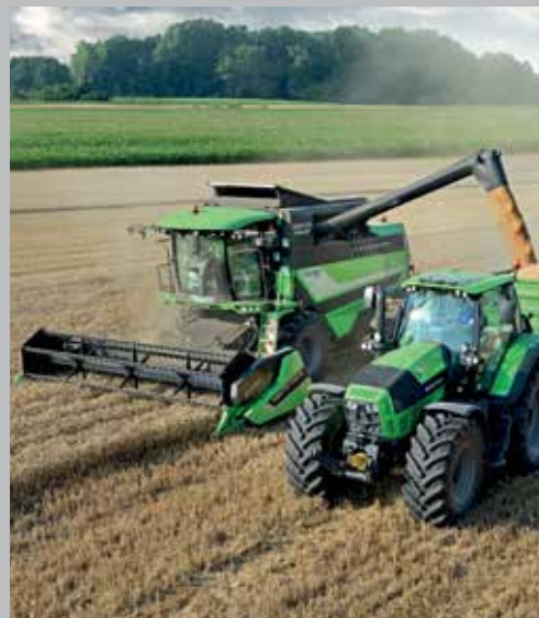
Tubo de descarga para vaciar el grano en un remolque mientras está trabajando en cualquier posición.
