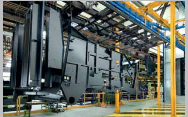
Todos los componentes son tratados con cataforesis y se les aplican los mismos procesos de pintura del sector de la automoción.
