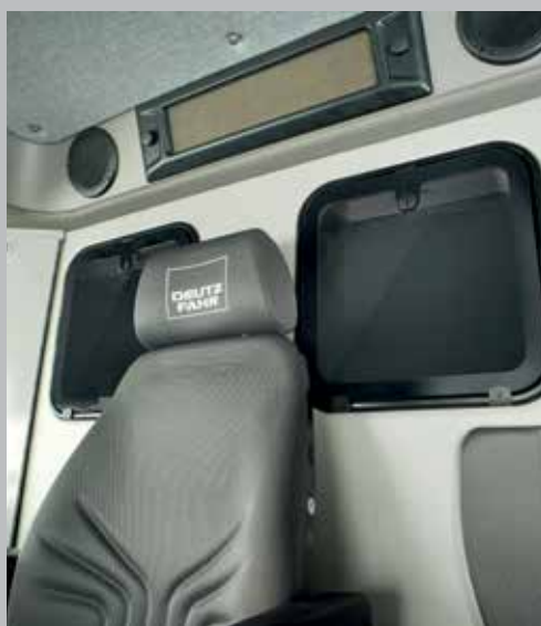
Doble ventana de inspección de la tolva del grano.
