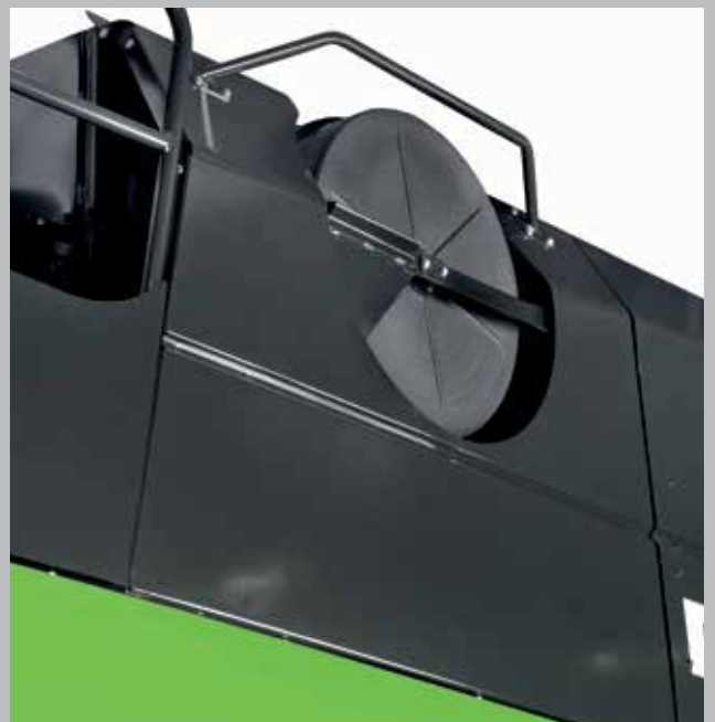
Gran pantalla giratoria para garantizar la máxima eficiencia del sistema de refrigeración.
