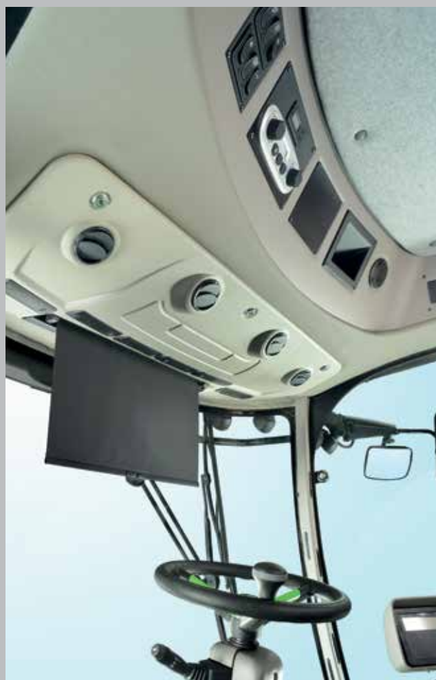
El innovador sistema de ventilación con aire acondicionado de alta eficacia y cortina parasol con autobloqueo.
