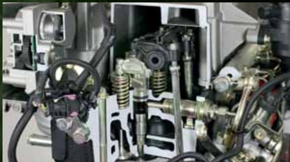
Los modernos motores DEUTZ, conformes a la normativa III B (Tier 4 Interim), montan cuatro válvulas por cilindro, sistema Common Rail y post-tratamiento de los gases de escape con SCR. Una combinación formidable la de este motor que le permite ofrecer excelentes prestaciones en cualquier condición. Gracias al sistema SCR, el motor trabaja de manera muy eficiente y sorprende al conductor con su bajo consumo.
