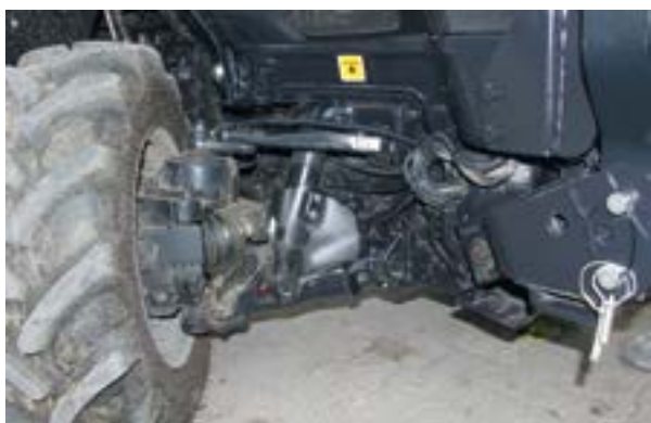
Grupa SDF z marką Deutz-Fahr na czele jest jedynym producentem ciągników sadowniczych z wielowahaczową przednią osią.
