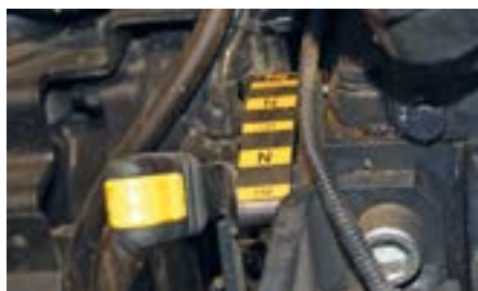
Zmiana prędkości tylnego wałka WOM wymaga niestety wyjścia z kabiny i przełożenia dźwigni z tyłu pojazdu.
