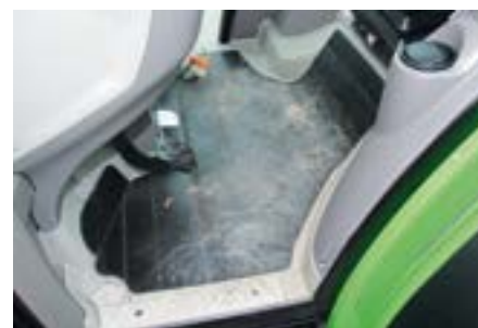
Płaska podłoga w klasycznym ciągniku rolniczym wrażeń nie robi. W segmencie sadowników jest to już jednak dość rzadki widok. Większość producentów stosuje bowiem tzw. tunel przekładniowy.
