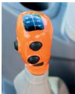
Skrzynia przekładniowa produkcji SDF 20/20 obsługiwana jest dwoma dźwigniami. Ta do zmiany pięciu biegów głównych ma na głowni 3 przyciski do załączania i wyciągania przełożenia powershift oraz elektrohydraulicznie sprzęgła biegów podstawowych.
