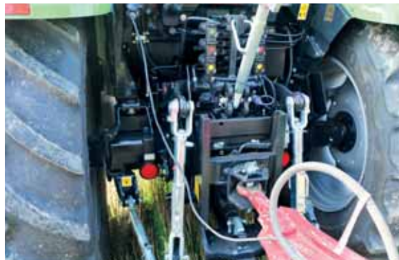
Gniazda hydrauliki zewnętrznej umieszczone są w znacznej odległości od siebie, co ułatwia wczepianie/wyczepianie przewodów hydraulicznych zakończonych szybkozłączkami.
