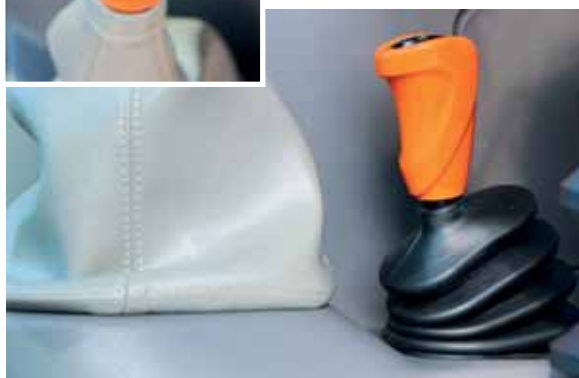
Skrzynia przekładniowa produkcji SDF 20/20 obsługiwana jest dwoma dźwigniami. Ta do zmiany pięciu biegów głównych ma na głowni 3 przyciski do załączania i wyciągania przełożenia powershift oraz elektrohydraulicznie sprzęgła biegów podstawowych.
