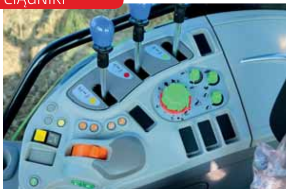
Sterowanie ramionami tylnego TUZ ciągnika Deutz-Fahr 5110 G odbywa się poprzez EHR. Blokady mostów i przedni napęd załączają się przyciskami.
