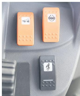
Pomarańczowe przyciski służą do załączania przedniego napędu i blokowania mechanizmu różnicowego. Czarny przycisk daje możliwość dezaktywacji funkcji wyłączenia silnika po opuszczeniu fotela przez operatora przy załączonym wałku WOM
