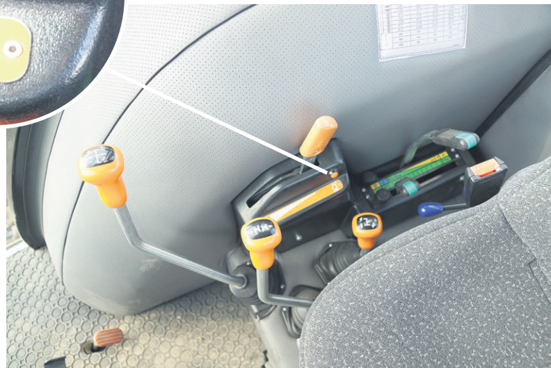
Przytrzymując przycisk umieszczony w okolicach dźwigni gazu ręcznego, można zapamiętać obroty silnika, które będą utrzymywane w trakcie pracy
