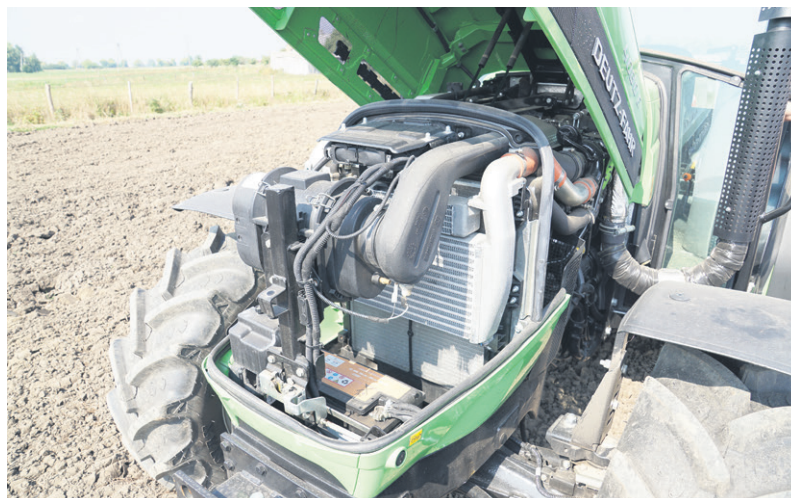
Deutz-Fahr 4080E ma trzy cylindry, 2,9 litra pojemności, posiada turbosprężarkę, a paliwo podaje w nim wysokociśnieniowy system common rail
