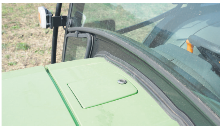
Wlew paliwa przykryty zamykaną klapką jest wyprowadzony w górnej części maski
