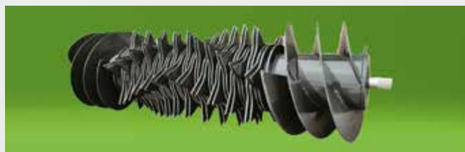
↑ Le système OC 23 coupe le fourrage à une longueur de 45 mm sur les modèles dotées d'un canal de passage pour balles de 120 cm. Avec un diamètre de 60 cm, le rotor OMNICUT est capable de prendre en charge n'importe quel andain. La forme brevetée\* des dents du rotor se traduit par une diminution de la puissance requise et une qualité de coupe parfaite. Les 23 couteaux sont dotés d'une protection hydraulique individuelle.
