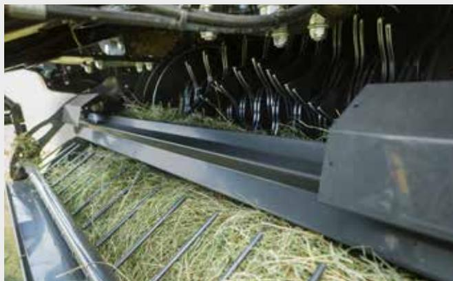
Paille, foin ou fourrage humide, le ROULEAU POWER FEED est le gage d'une capacité accrue. Ce rouleau d'alimentation actif suit précisément la hauteur de l'andain.
