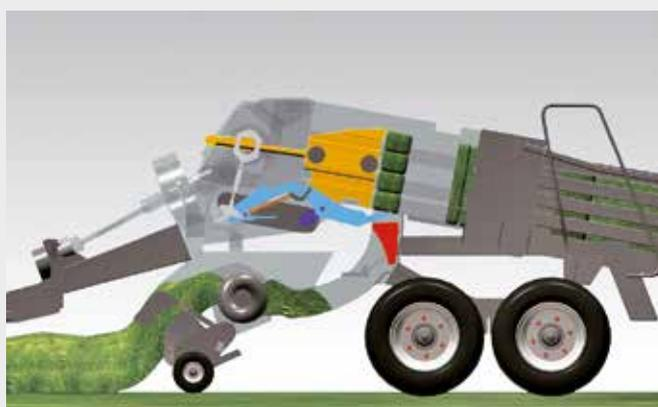
4. Une fois le palpeur repoussé, il active la seconde fonction du système de l'ameneur. La fourche fait un mouvement longitudinal qui vide la chambre de pré-compression et pousse le paquet parfaitement formé dans la chambre de compression.
