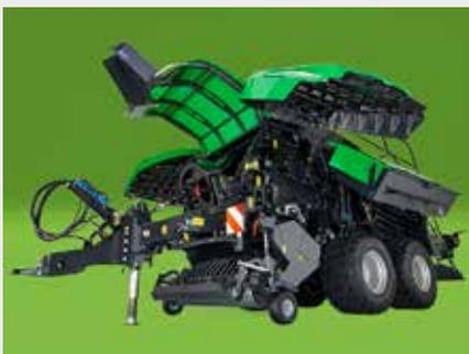
↑ Les coffres de stockage de la ficelle s'inclinent sur le côté, afin de permettre un accès aisé aux organes de la presse. Derrière les deux capots latéraux offrant un accès complet, des bobines de ficelle de 32 x 13 kg peuvent être rangées.
