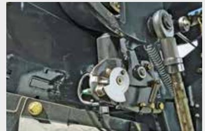
Système de réglage électrique de la longueur de balle
