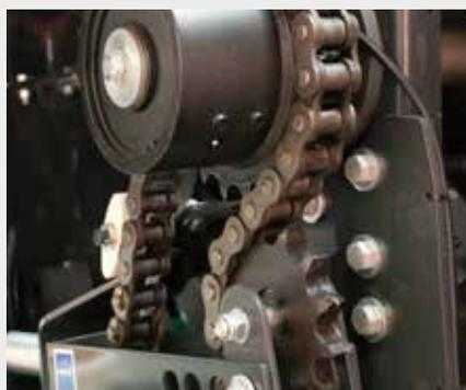
↑ Tous les éléments du système d'alimentation des presses haute densité de DEUTZ-FAHR sont équipés d'une protection complète par limiteur à cames. Ce système de sécurité sans arrêt vous permet en cas de surcharge de relancer la machine sans quitter le siège de la cabine.
