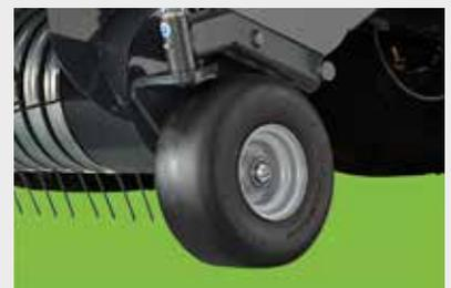
Roues de jauge de pick-up pivotantes semi-pneumatiques
