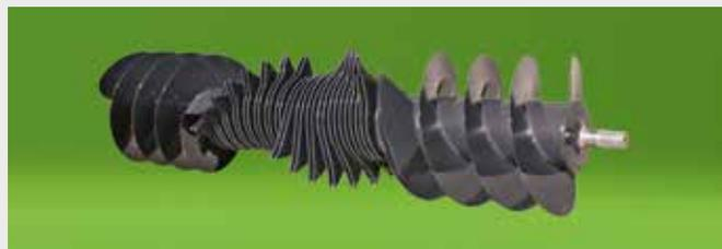
↑ Le système OC 15 coupe le fourrage à une longueur de 45 mm sur les modèles de machine dotées d'un canal de passage pour balles 80 cm. La forme brevetée\* des dents du rotor se traduit par une diminution de la puissance requise et une qualité de coupe parfaite. Chaque couteau, doté d'une protection individuelle contre les surcharges par ressort, peut être remplacé facilement grâce au système de montage sur cassette intégré.
