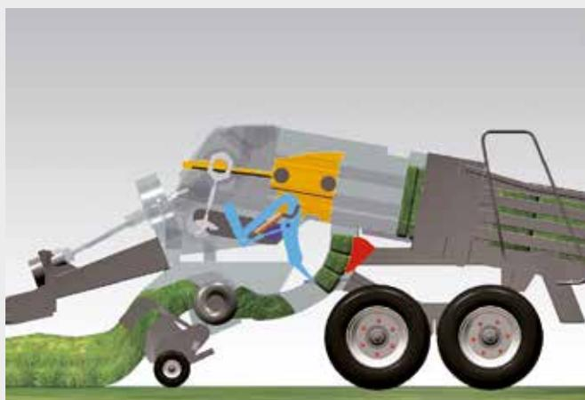
3. L'ameneur à fourche simple continue de former le paquet jusqu'à ce que le palpeur de mesure (rouge) soit repoussé à une force déterminée.
