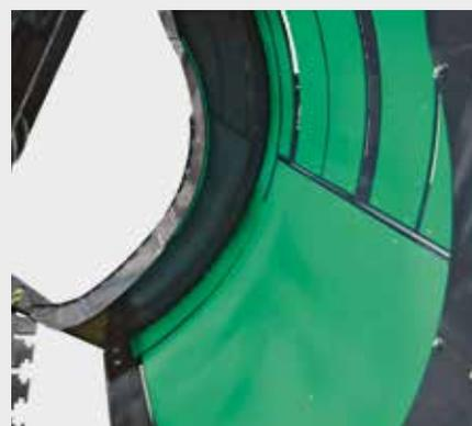
↑ Afin d'améliorer encore les performances de la machine pour le pressage de matières humides ou collantes, un kit d'optimisation du flux peut être monté dans la chambre de pré-compression.
