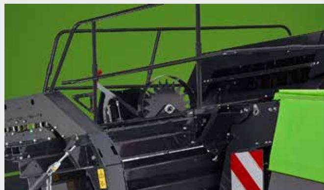
↑ La longueur de la balle est mesurée à l'aide d'une roue crantée au centre de la chambre de compression. Le chauffeur suit la taille de la balle et le nombre de balles produites sur le terminal.
