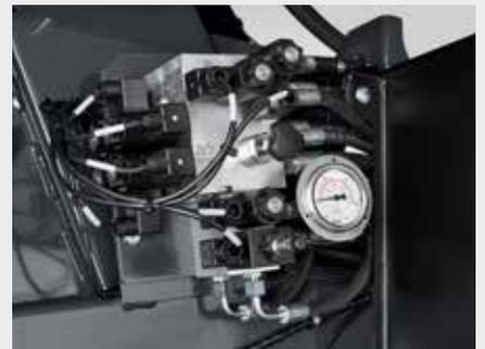
↑ Tous les modèles BIGMASTER sont équipés d'un système hydraulique de détection de charge. Il est utilisé pour le verrouillage de l'axe, la commande des coupeaux, la rampe à rouleau et l'éjection des balles.
