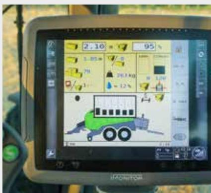
↑ Toutes les presses haute densité peuvent être équipée d'un capteur d'humidité étalonnable avec une plage de mesure comprise entre 9 et 40 % d'humidité.
