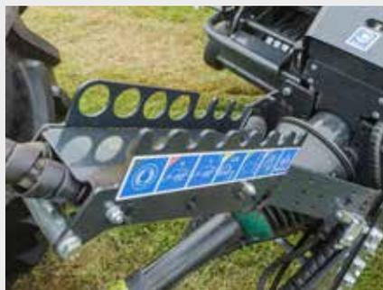
↑ Pour une machine propre et bien rangée, la presse est équipée d'un support pratique pour le rangement des flexibles hydrauliques et des câbles nécessaires au fonctionnement de la machine.
