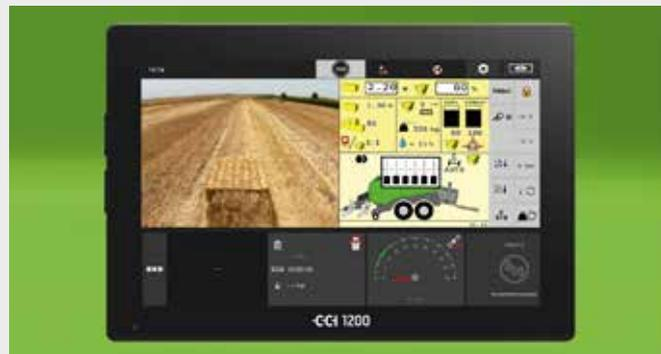
↑ La commande de la configuration des groupes de couteaux s'effectue aisément depuis le siège du tracteur, via le terminal. Le chauffeur peut choisir les configurations des groupes de couteaux : 0 – 11 – 12 – 23.
