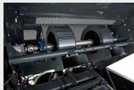
↑ Deux énormes souffleries à entraînement hydraulique sont installées de série et assurent un nettoyage performant de la zone de liage, même dans des conditions très poussiéreuses.
