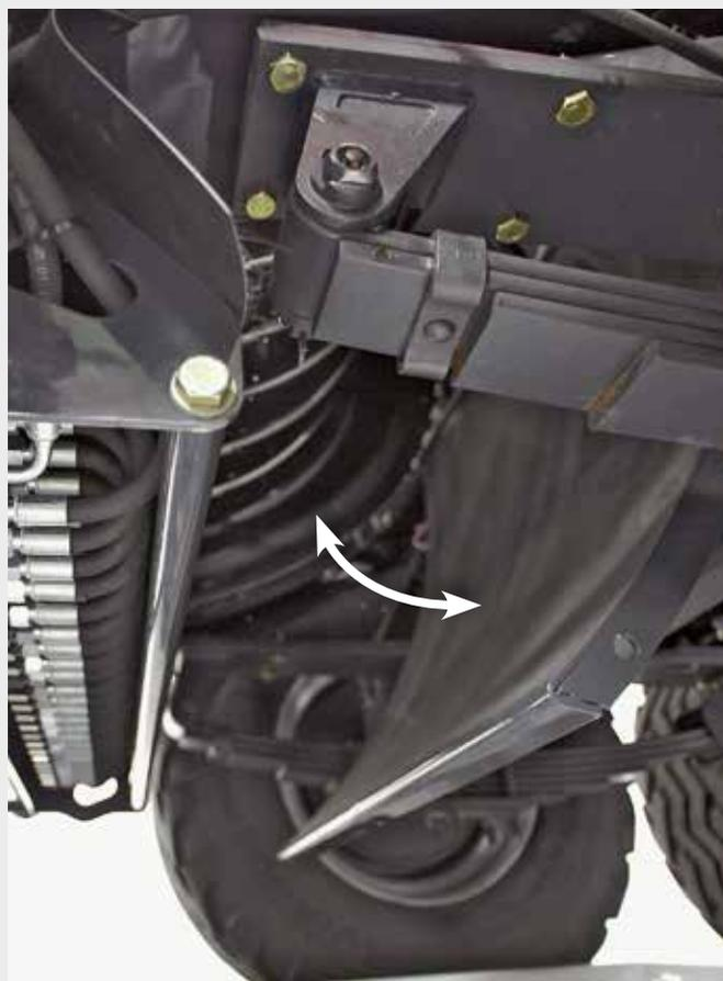
La chambre de pré-compression est dotée d'une caractéristique exclusive : une trappe de visite par le dessous. Pour faciliter l'accès à la chambre de pré-compression, il est possible d'ouvrir complètement la partie basse sans aucun outil.
