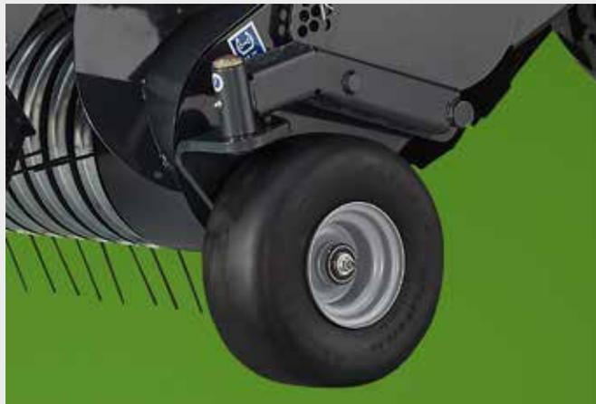
Pour adapter la machine à vos besoins, vous avez le choix entre des roues de jauge fixes ou pivotantes. Les roues de jauge pivotantes sont semi-pneumatiques et donc idéales pour les conditions difficiles et les sols caillouteux.
