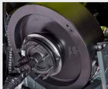
↑ Le volant de 485 kg est la garantie d'une machine au fonctionnement fluide, offrant un confort de conduite maximum.
