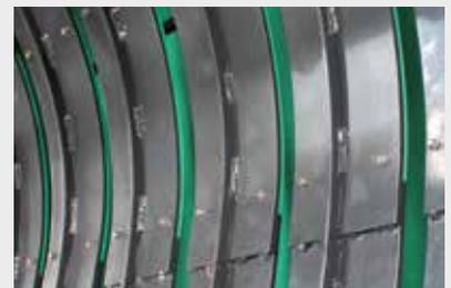
Plaques Téflon facilitant le flux pour la chambre de pré-compression
