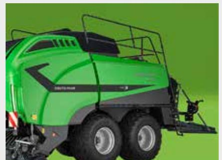
↑ Pour plus de sécurité, la plate-forme du noueur est équipée d'une échelle et d'une rampe de sécurité. La rampe peut être rabattue facilement afin de diminuer la hauteur de la machine pour le transport.
