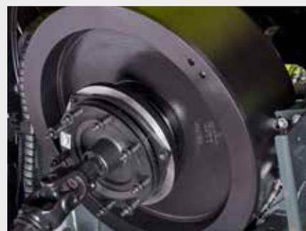
↑ El robusto volante de inercia de 485 kg garantiza una marcha excepcionalmente suave de la máquina, ofreciendo al trabajador la máxima comodidad de conducción durante las operaciones diarias.
