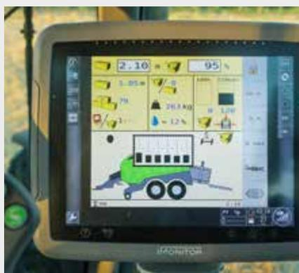
Todas las empacadoras de alta densidad pueden ser equipadas con un sensor de humedad calibrable con un rango de medición de entre el 9 y el 40% del contenido de humedad.
