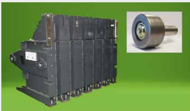
46 carreras por minuto del pistón dan como resultado una gran capacidad de compactación. El pistón está guiado mediante 4 rodillos grandes de 125 mm de diámetro para una máxima vida útil.
