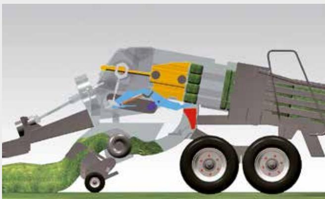
4. Una vez empujada hacia atrás la placa de medición, esta activa la segunda función del sistema de horquilla de alimentación. La horquilla hace un movimiento diferente que vacía la cámara de precompresión y empuja el material perfectamente formado a la cámara de empacado.
