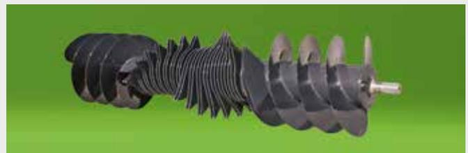
El sistema OC 15 ofrece una longitud de corte de 45 mm en los modelos de canal de formación de pacas de 80 cm de anchura. La forma de las púas del rotor, patentada\*, garantiza una baja potencia requerida y una calidad de corte perfecta. Las cuchillas, protegidas individualmente contra sobrecargas mediante un muelle, pueden cambiarse fácilmente gracias al sistema de grupos de serie integrado.
