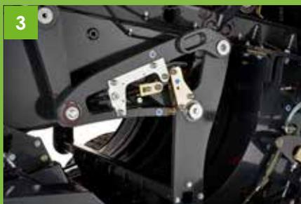
Sistema de cámara de precompresión POWER DENSITY
