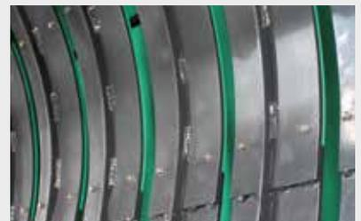
Placas de circulación fácil (Easy flow) para la cámara de precompresión
