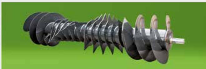
El diseño del rotor OPTIFEED, donde las púas del rotor - fabricadas con placa de desgaste Hardox® - y la función de los dos sinfines se combinan en un eje, permite uniformar la hilera distribuyendo el forraje de manera uniforme para pacas homogéneas en todo momento. Cuando no es necesario cortar el forraje, el sistema OPTIFEED garantiza un flujo controlado y homogéneo del cultivo a la cámara de precompresión. Con el rotor, se añade a la máquina un nivel adicional de protección.
