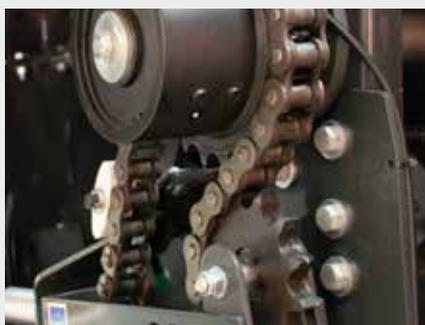
↑ Todos los componentes principales del sistema de alimentación de las empacadoras de alta densidad DEUTZ-FAHR cuentan con un embrague de tipo leva. Con este sistema de seguridad de activación Non-Stop se puede desbloquear la máquina en marcha desde el asiento del conductor en caso de que haya una sobrecarga.
