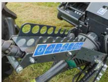
↑ Para un almacenamiento limpio y práctico, las empacadoras están equipadas con un práctico compartimento para almacenar los tubos y cables necesarios para el funcionamiento de la máquina.
