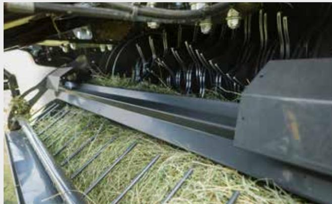
Independientemente de si va a empacar paja seca, heno o ensilado húmedo, el RODILLO DE ALIMENTACIÓN POWER FEED le permite llevar la capacidad al siguiente nivel. Este rodillo retenedor de forraje con tracción sigue activamente la altura de la hilera.
