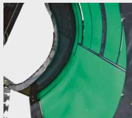
Para mejorar aún más el rendimiento de la máquina para el empacado con material húmedo o pegajoso, se puede equipar la cámara de precompresión con un Kit Easy Flow (de circulación fácil).
