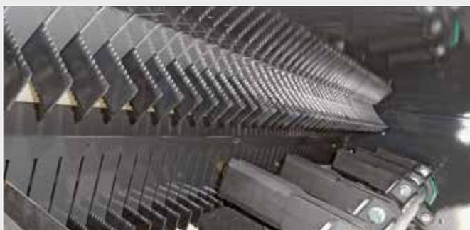
↑ La altura de trabajo de la CBB 200 ofrece un amplio rango de ajustes para adaptarse al máximo a las condiciones y circunstancias específicas. Con un despeje de 65 cm, no hace falta retirar el CBB 200 de la máquina cuando no se requiera desmenuzamiento previo.
