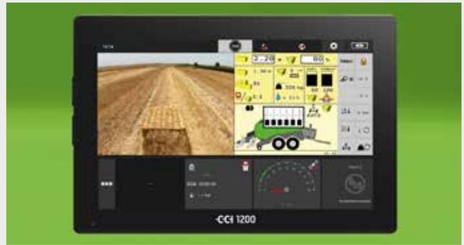
El funcionamiento de la configuración de cuchillas por grupos se realiza fácilmente desde el asiento del tractor a través del terminal. El usuario puede escoger entre las siguientes configuraciones de cuchillas por grupos: 0 – 11 – 12 – 23.
