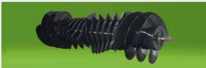
El diseño del rotor Biomasa OPTIFEED combina todas las ventajas del rotor estándar OPTIFEED con púas del rotor atornillables fabricadas con placa de desgaste Hardox® para una durabilidad excelente y de cambio fácil. Estas púas del rotor están especialmente diseñadas para los forrajes energéticos agresivos tales como hojas de caña de azúcar.
