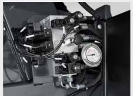
↑ Todos los modelos BIGMASTER están equipados con un sistema hidráulico load sensing. Este sistema se utiliza para el bloqueo del eje de dirección, gestión de las cuchillas, rampa de descarga y funciones del expulsor de pacas.
