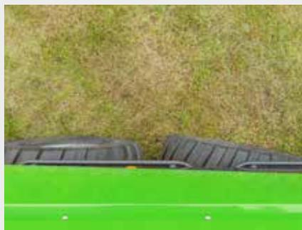
↑ El eje tándem direccionado XL levanta la barra con una enorme facilidad de manipulación. Es capaz de montar neumáticos grandes 680/50R22.5 para reducir la compactación del suelo.
