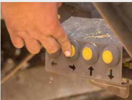
↑ El mecanismo de expulsión de la última paca se usa para despejar toda la cámara de empacado al cambiar entre forrajes o por la limpieza de final de temporada. El mecanismo de expulsión de paca de dos pasos opcional puede expulsar la última paca formada completamente o puede despejar toda la cámara de empacado.
