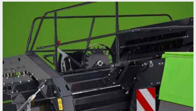
La longitud de la paca se mide con una rueda de estrella en el centro de la cámara de empacado. El operador monitoriza el tamaño de la lámina y el número de láminas a través del terminal.
