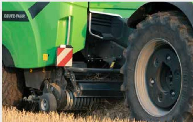
El pick-up cuenta con un diseño mediante leva, que da el movimiento óptimo para que los dientes cojan el forraje y reduzcan al mínimo su trillado.
