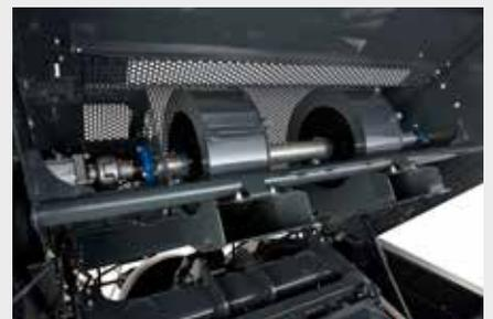
**3** Dos turboventiladores macizos accionados hidráulicamente están equipados de serie y dan un rendimiento de limpieza del dispositivo de atado óptimo en la mayoría de las condiciones más polvorientas y desafiantes.
