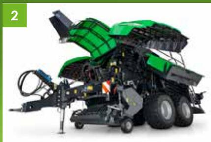
Compartimentos pivotantes para un mantenimiento fácil
