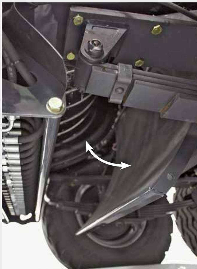
Una característica distintiva es la trampilla de inspección en la parte inferior de la cámara de precompresión. Para facilitar el acceso a la cámara de precompresión se puede abrir completamente la parte inferior sin necesidad de utilizar herramientas especiales.
