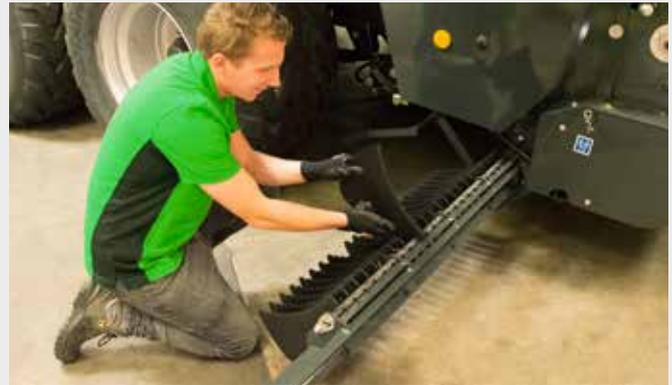
Las púas del rotor atornillables fabricadas con placa de desgaste Hardox® garantizan un cambio fácil. Junto con el sistema de grupos de serie para cambiar fácilmente las cuchillas, no solo invertirá en calidad de corte, sino también, y, sobre todo, en la comodidad de trabajo.
