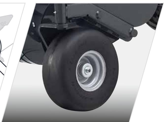
> Roues de pick-up pivotantes et semi-pneumatiques idéales pour les terrains accidentés.
