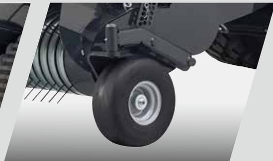
> Roues de jauge de pick-up pivotantes et semi-pneumatiques.
