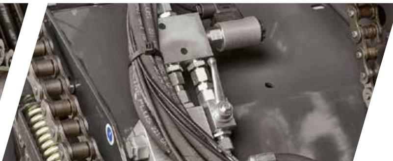
5 Contrôle des couteaux / de la trappe escamotable DROPFLOOR séparé, actionnés depuis la cabine du tracteur (en option pour OPTIFEED).
