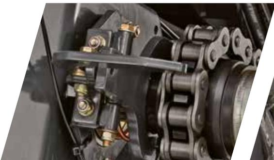
4 Débrayage mécanique du rotor.
