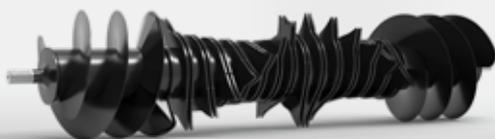
> Le ROTOR INTÉGRAL, doté du système OPTICUT à 14 coupeaux (OC14).
