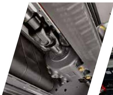
7 Arbres d'entraînement avec joints de cardan intégrés.
