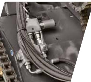
6 Contrôle des couteaux / de la trappe escamotable DROPFLOOR séparé, actionnés depuis la cabine du tracteur.
