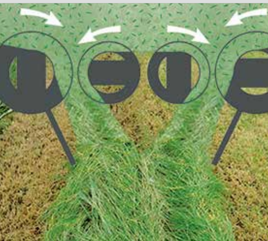
> Typische mesplaatindeling met grote en kleine trommels voor smalle zwaden.
