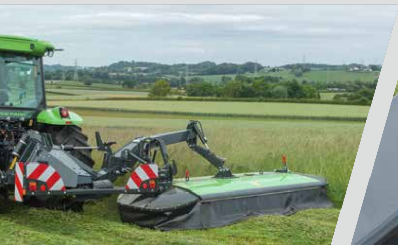
> Getrokken hefgeometrie van de aanbouwbok.
