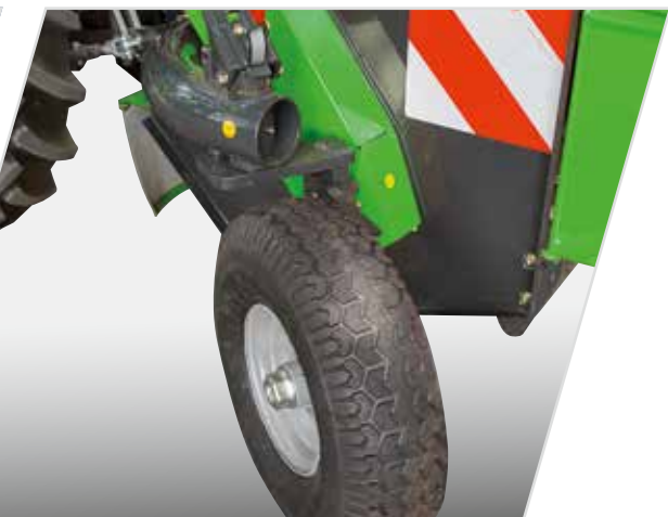
> Grote zwenkbare wielen voor perfecte bodemaanpassing.
