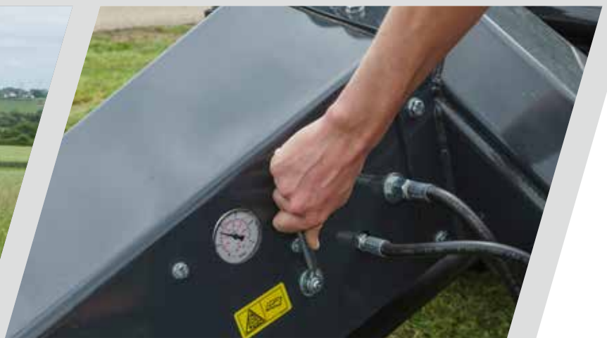
> Het LIFT-CONTROL hydropneumatische ophangstelsel.
