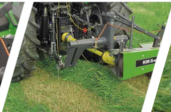
> Speciale adapter voor bredere tractoren.
