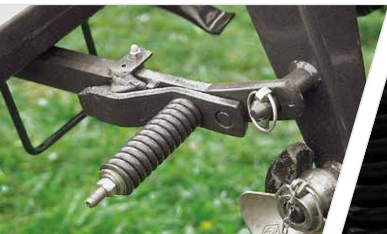
> Dispositif de sécurité à déclenchement.
