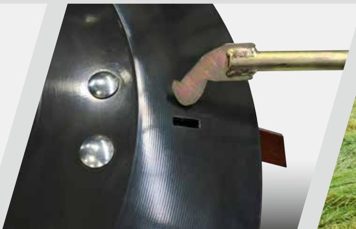
> Changement rapide des couteaux avec peu de force et une sécurité maximale.
