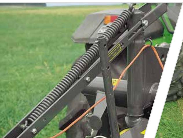
> Les ressorts de suspension permettent de réduire la pression au sol.
