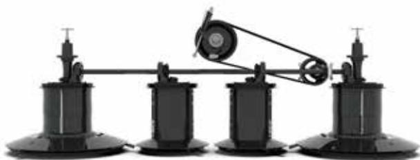
> Transmission à courroie en V.
