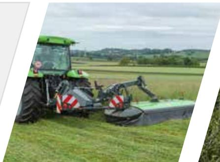
2 Cabezal con geometría de enganche remolcada.
