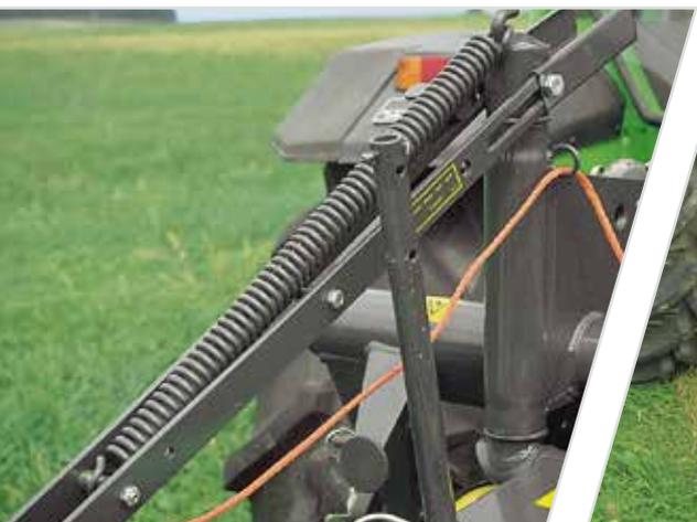
> Los muelles de compensación mantienen baja la presión sobre el suelo.
