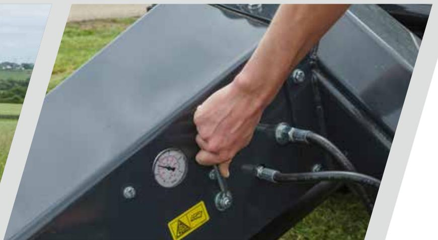
> El sistema de suspensión hidroneumática LIFT-CONTROL.
