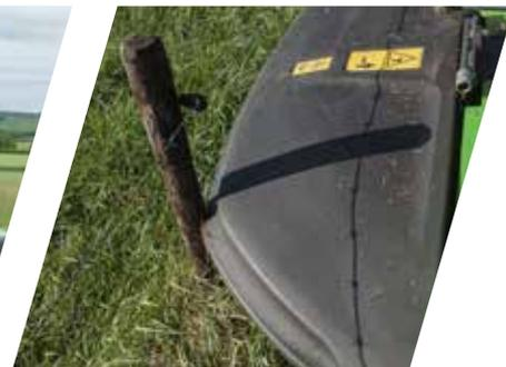
3 Cubierta lateral flexible FLEXPROTECT rediseñada y patentada\*.
