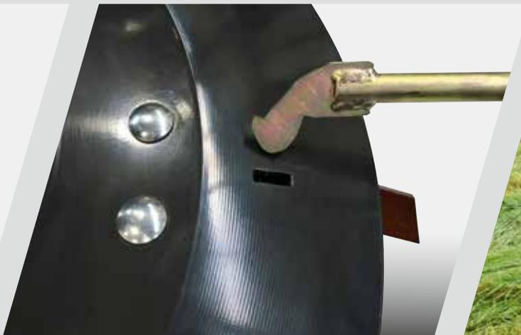
> Cambio rápido de cuchillos con mínima fuerza y máxima seguridad.
