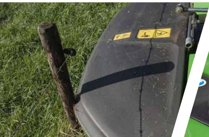
> Cubiertas flexibles laterales FLEXPROTECT.
