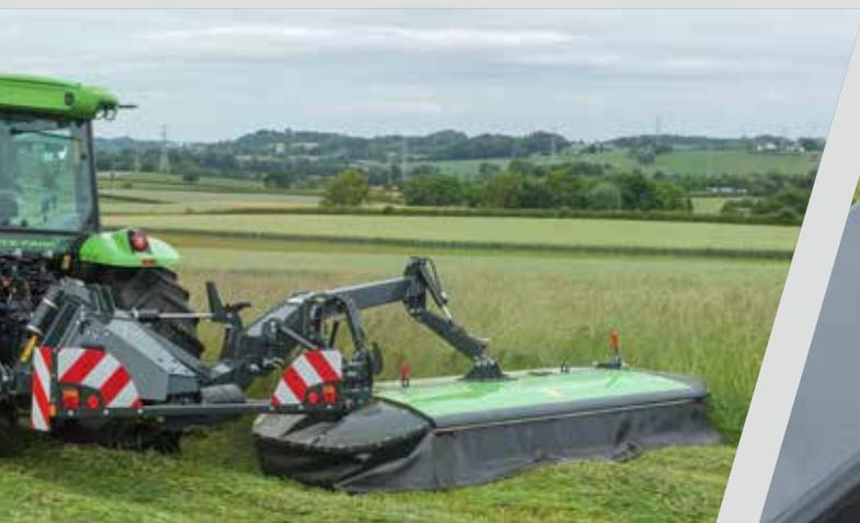
> Cabezal con geometría de enganche remolcada.
