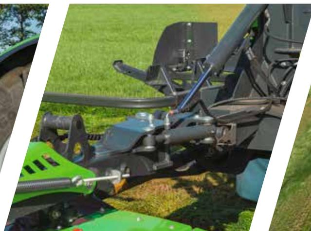
> Sistema de seguridad de retroceso hidráulico LIFT-CONTROL.
