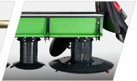
5 Serienmäßige Schwadscheiben für eine schmale Schwadablage.
