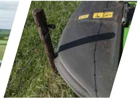
3 Patentierte* Seitenschutz FLEXPROTECT aus biegsamem Material.
