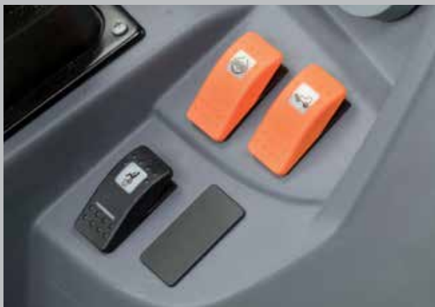
Accionamiento mecánico o electrohidráulico opcional de la doble tracción y del bloqueo de diferenciales.
