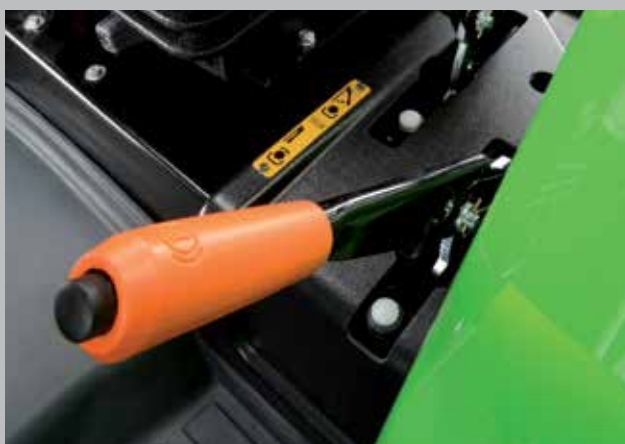
Freno de estacionamiento mecánico instalado al lado del asiento del conductor para poder accionarlo fácilmente.
