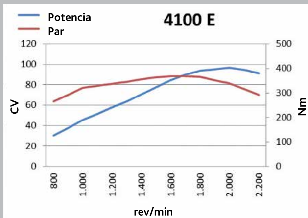
Máxima potencia y par constante incluso a bajo régimen de revoluciones.
