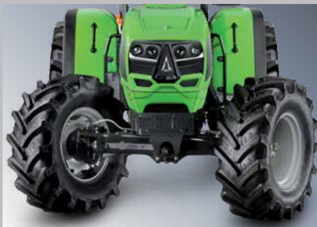
El capó compacto permite un ángulo de giro máximo de 55 grados.
