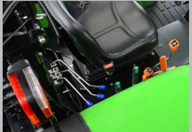
Hasta tres distribuidores traseros de control mecánico.
