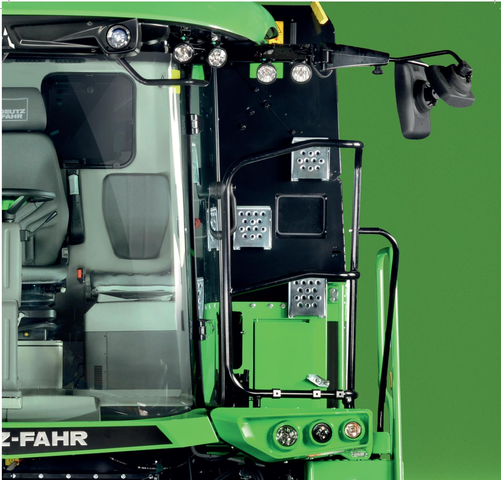
La COMMANDER CAB EVO II incarne des standards élevés de confort et de technologie afin de rendre le travail moins fatigant et surtout de garantir une sécurité absolue pour l'opérateur. Les commandes électriques des fonctions de battage sont à portée de main sur le tableau de bord, à droite du conducteur. La commande de la transmission et l'activation
