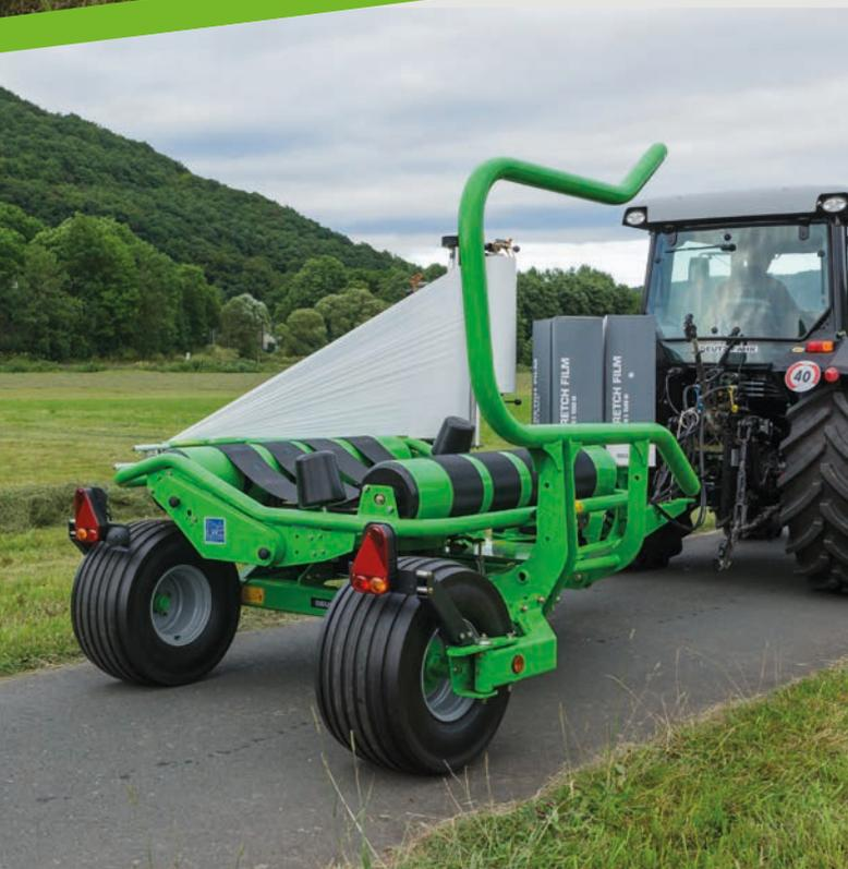
GERINGERE TRANSPORTBREITE DURCH EINKLAPPUNG EINES RADES.
