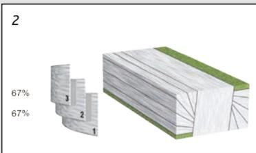
2 AUSWAHL VON 5 FOLIENLAGENDER BALLE WIRD MIT 3 FOLIENLAGEN BEI EINER ÜBERLAPPUNG VON 67% UMWICKELT
