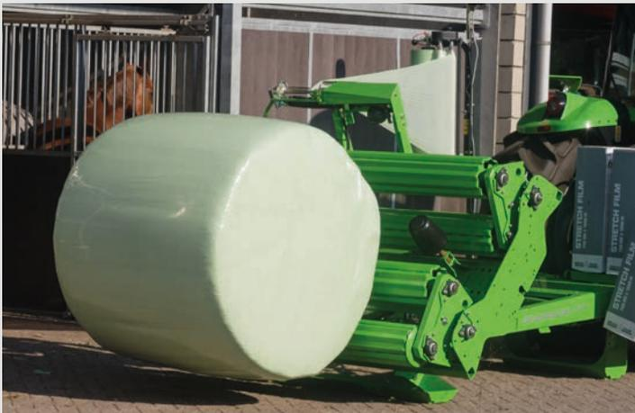
*DANK DER GERINGEN HÖHE DES WICKELTISCHES WIRD DER BALLE SANFT AUF DEN BODEN GEKIPPT, OHNE DASS DIE FOLIE BESCHÄDIGT WIRD.*
