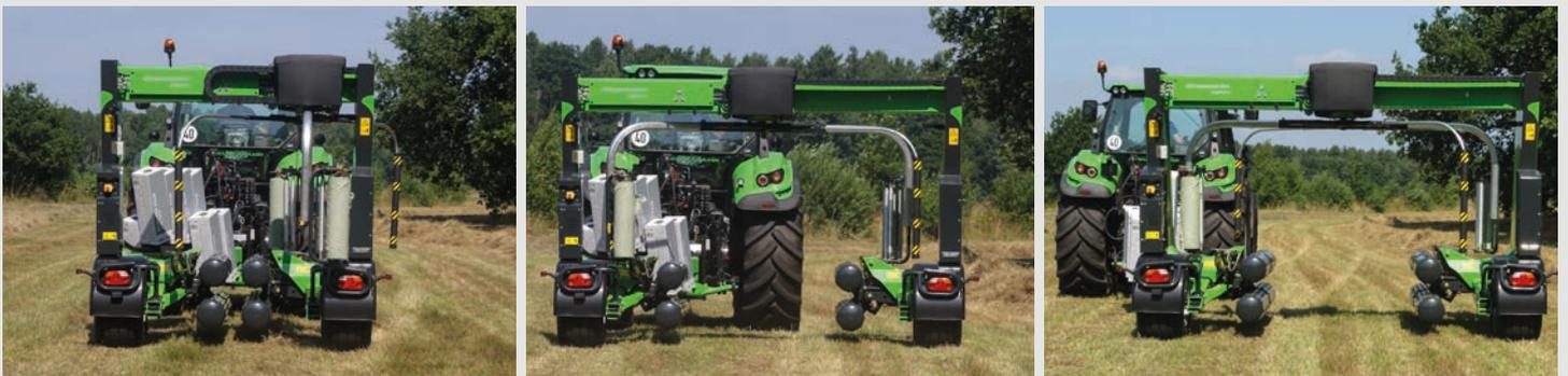
DER WICKLER WIRD VON DER TRANSPORTSTELLUNG MIT 2,5 M AUF DIE ARBEITSSTELLUNG MIT 4 M AUSGEFAHREN.
