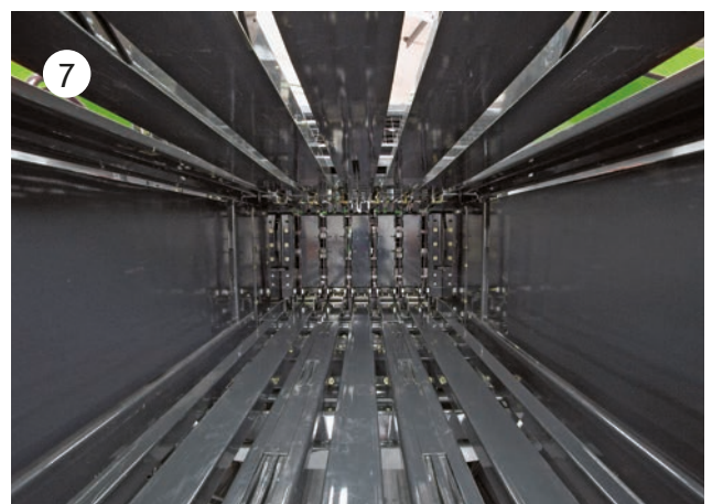
3 M (9' 10") PERSKAMER, MET LAATSTE BAALUITWERPER
