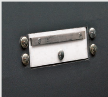
VOCHTMETING GEÏNTEGREERD IN ISOBUS ELEKTRONICA
