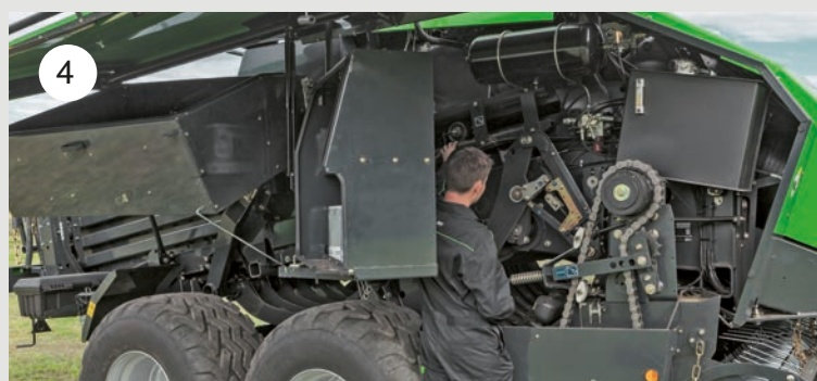
SCHARNIERENDE TOUWKASTEN VOOR GEMAKKELIJKE TOEGANG TOT DE MACHINE
