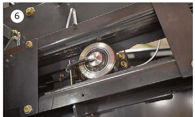
HOGE CAPACITEIT VAN DE PERSWAGEN – 46 SLAGEN/MIN. - 12,5 CM DIAMETER PERSWAGEN ROLLERS
