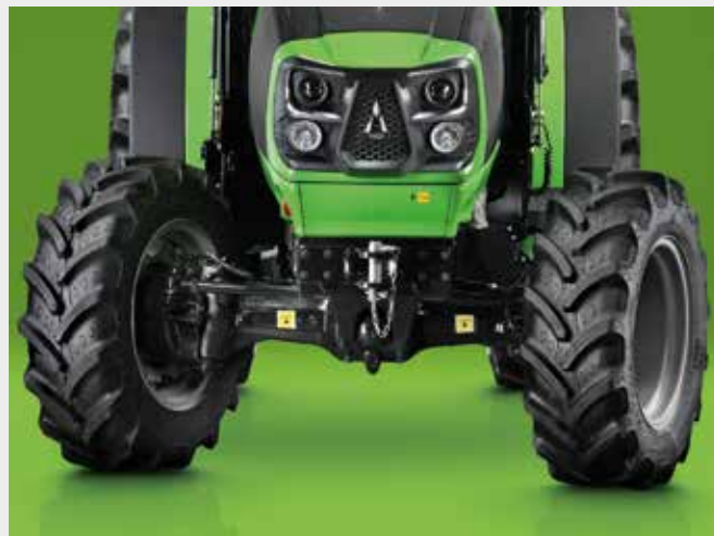
↑ Prawdziwe hamowanie 4 kołami dzięki hamulcom na przedniej osi.
