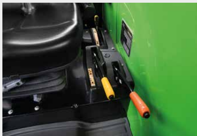
↑ Mechaniczny selektor prędkości i załączania WOM.
