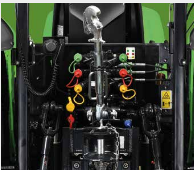
Do 3 obwodów z regulatorem przepływu i wolnym powrotem.
