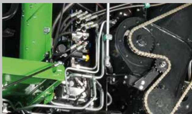
Wszystkie elektrozawory zgrupowano obok wejścia do kabiny.
