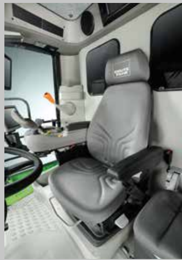
Duży fotel operatora ze zintegrowanym podłokietnikiem oraz wielofunkcyjnym joystickiem.
