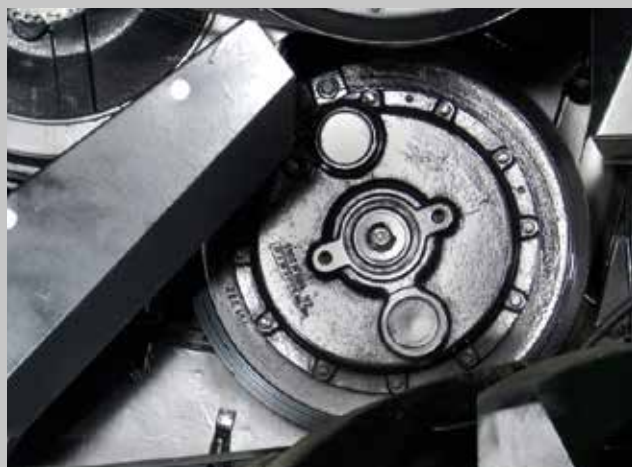
Opcjonalny reduktor bębna młójącego zmienia prędkość w zakresie 1250 do 625 oraz 420 do 210 obr/min.
