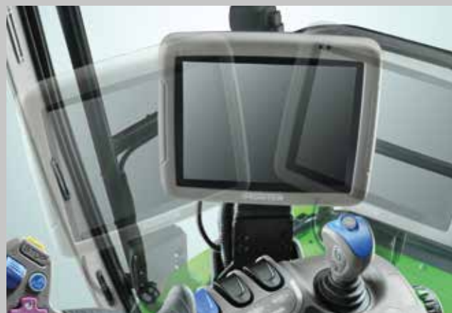
Łatwa regulacja umiejscowienia monitora na podłokietniku.
