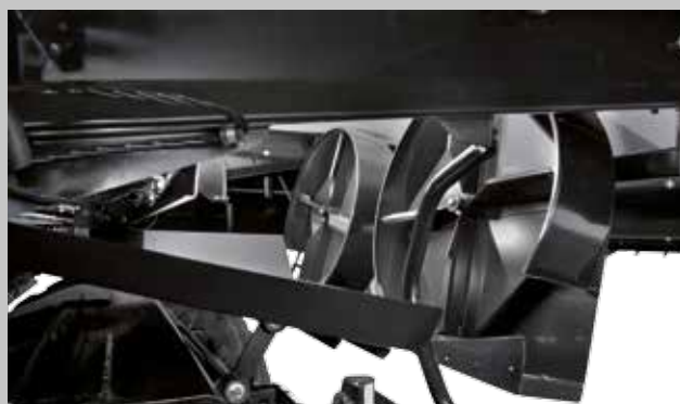
Plewy rozrzucane są na całej szerokości roboczej kombajnu dzięki wydajnym wirnikom rozrzutnika.
