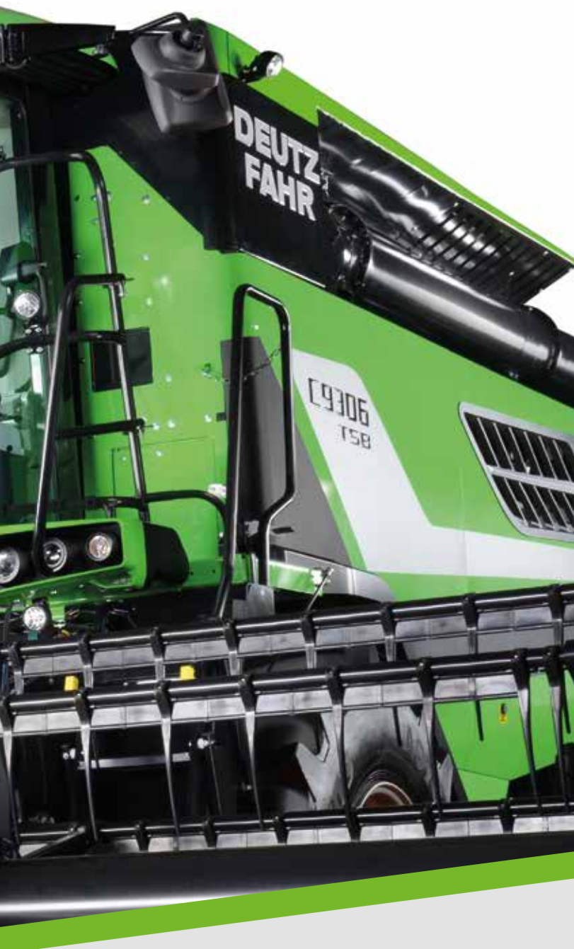
Nawet do 10 reflektorów roboczych na kabinie, reflektory z boku i z tyłu - dla zapewnienia doskonałej widoczności dookoła kombajnu w trakcie prac w nocy.
