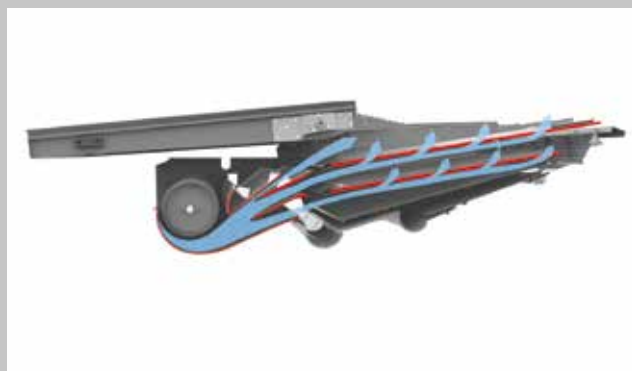
Wentylator turbinowy zapewnia stały nadmuch powietrza na całej szerokości kombajnu.
