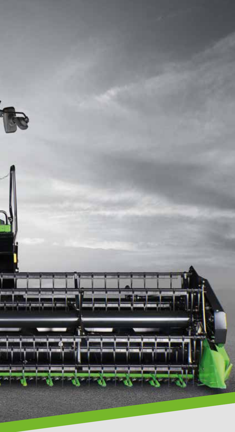
System SCHUMACHER EASY CUT II: szybkość 1220 cięć na minutę przy małych stratach i wibracjach.
