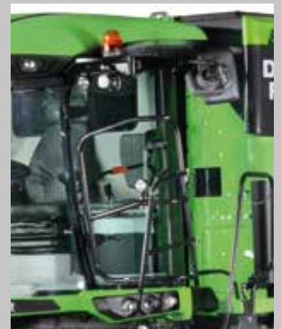
Podwójne okno inspekcyjne w kabinie, łatwe pobieranie próbek obok kabiny.
