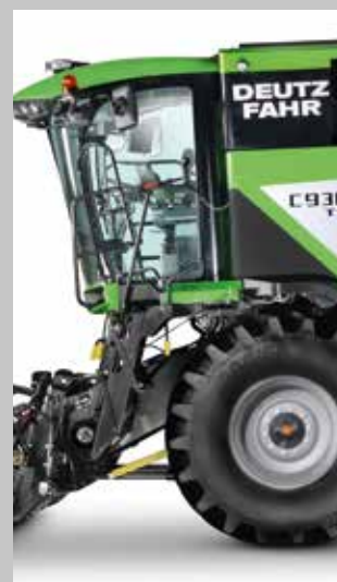
Łatwy i bezpieczny dostęp do kabiny dzięki drabinie ze składanymi stopniami. System składania schodków pozwala na utrzymanie kompaktowej bryły kombajnu.
