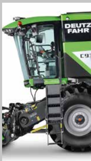
Łatwy i bezpieczny dostęp do kabiny dzięki drabinie ze składanymi stopniami. System składania schodków pozwala na utrzymanie kompaktowej bryły kombajnu.
