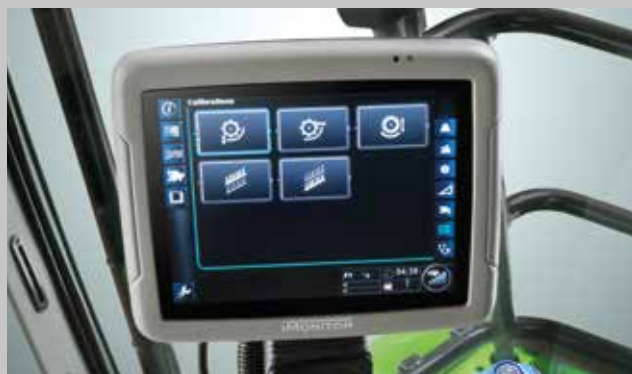
Kalibracje systemów wykonywane poprzez iMonitor w kabinie.
