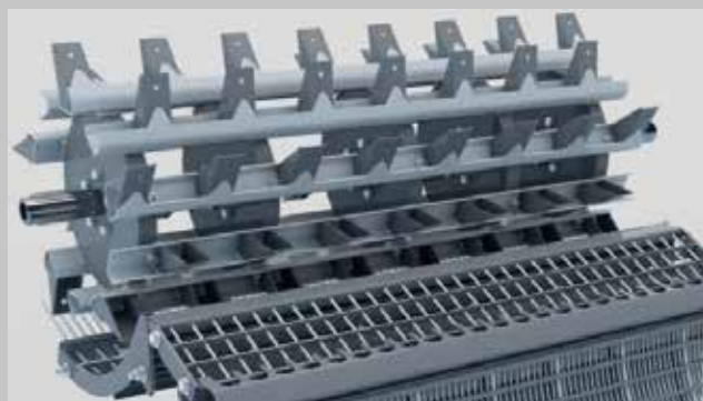
Turboseparator o dużej średnicy 590 mm posiada oddzielne klepisko, zwiększa wydajność pracy kombajnu o 20%. Możliwość regulacji w 5 pozycjach pozwala dostosować parametry do zbieranego plonu. Dostępna jest także regulacja prędkości obrotowej w zakresie od 775 obr./min w przypadku małych ziaren do 410 obr./min w przypadku dużych ziaren.
