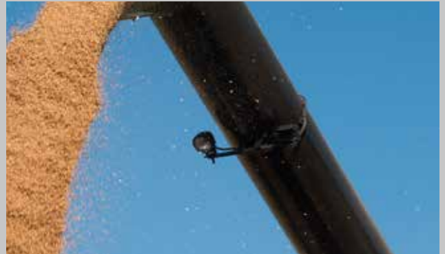
Dodatkowy reflektor i kamera ułatwiają wyładunek ziarna.
