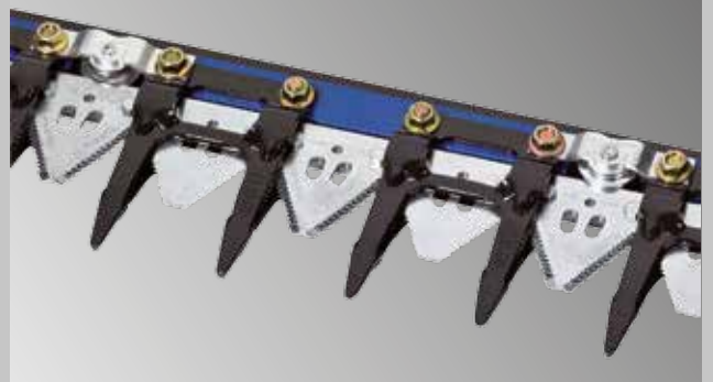
Dodatkowe rolki prowadzące kosę (opcja) redukują wibracje i obciążenie nożyków.
