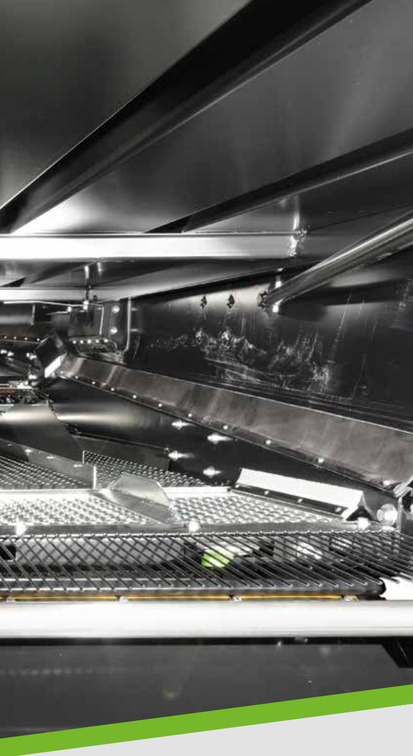
Długie, otwarte wytrząsacze o powierzchni 6,92 m 2 w modelu C9306 i 5,80 m 2 w modelu C9305.
