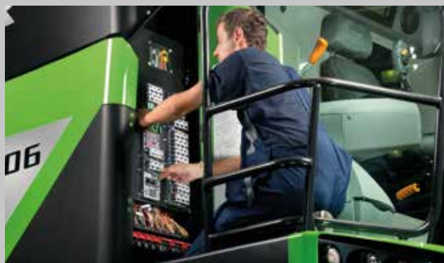
Skrzynka bezpieczników obok kabiny.
