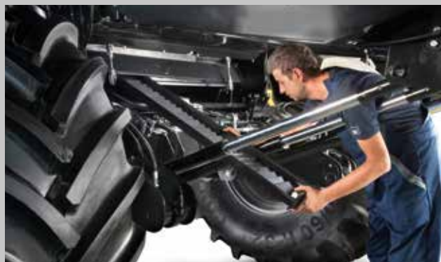
Demontaż segmentów podsiewacza z przodu kombajnu.
