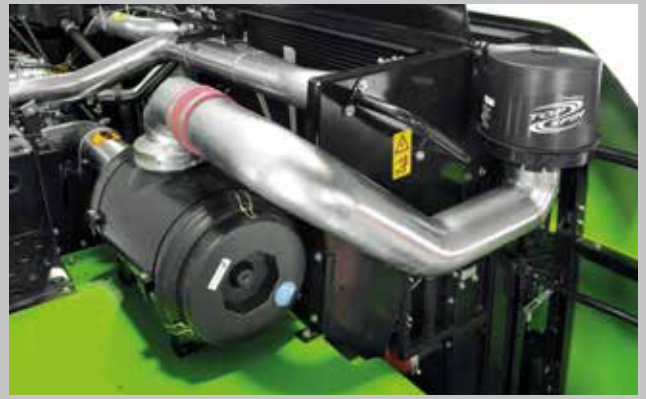
System czyszczenia powietrza z filtrem wstępnym.
