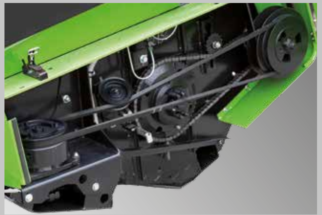
System SCHUMACHER EASY CUT II: szybkość 1220 cięć na minutę przy małych stratach i wibracjach.
