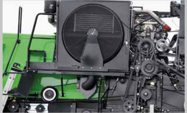
Duże chłodnice z dodatkowym systemem czyszczenia.
