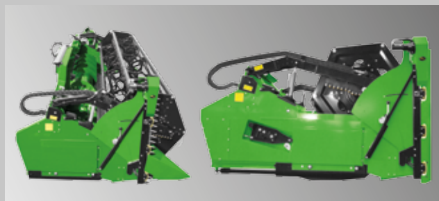
Podłoga hedera może być wysuwana hydraulicznie w zakresie do 700 mm. Pionowe noże boczne są napędzane hydraulicznie.
