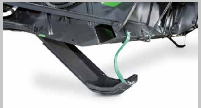
Płozy pod hederem połączone z czujnikami pozwalają na prowadzenie hедера tuż nad powierzchnią gruntu.
