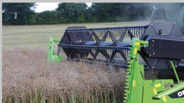
Zbiór rzepaku może być wykonywany za pomocą hederów DEUTZ-FAHR do 7,2 metra, wyposażonych w zestaw z przystawką.
