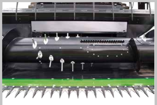
Przenośnik ślimakowy dużej średnicy z palcami ułożonymi spiralnie na jego środkowej części.
