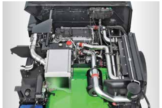
MOCNY SILNIK MERCEDES BENZ OM936 7.7 L TIER4 FINAL / EURO 4. Jednostka napędowa zaprojektowana do prac z dużymi obciążeniami.
