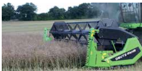
Zestaw do zbioru rzepaku montowany na klasycznym hederze zwiększa wszechstronność kombajnu.
