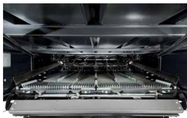
Opcjonalnie, kombajny C7000 wyposażane są w sterowany elektrycznie układ regulacji sit.
