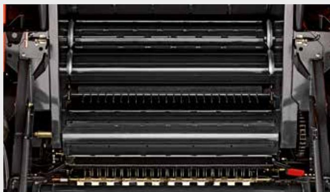
La concezione della camera di compressione della serie VARIMASTER 700 BALEPACK con 5 cinghie e 3 rulli, assicura la formazione veloce e consistente delle balle, qualsiasi sia il sistema di alimentazione. L'unicità data dal mix del sistema PROGRESSIVE DENSITY e del concetto ingegnoso della camera di compressione assicura una formazione perfetta della balle con ogni tipo di foraggio.
