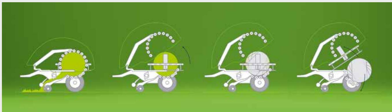
↑ Grazie al design unico della COMPACMASTER+, con fasciatura integrato, due operazioni sono combinate in un'unica macchina. Questa macchina molto compatta e leggera pesa solo 3700 kg.
