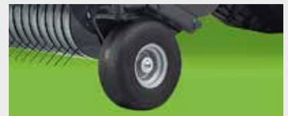
Ruote pick-up pivotanti semi-pneumatiche
