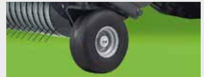
Ruote pick-up pivotanti semi-pneumatiche
