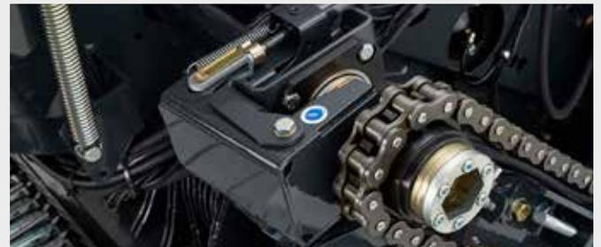
In casi estremi la doppia sicurezza è garantita da una frizione di disinnesto rotore disponibile di serie. Questo permette all'operatore di legare e scaricare la palla dalla camera di pressatura e poi poter ripartire a pressare il foraggio, senza il problema di dover caricare la palla non legata.
