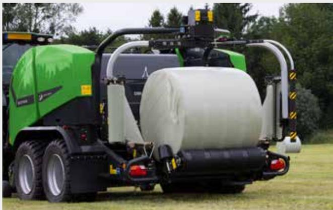
↑ Gli ingredienti chiave della palla perfetta sono una forma ottimale e l'alta densità. La combinazione del ROTORE INTEGRALE e del design unico della camera di pressatura dà come risultato una forma perfetta della palla con un riempimento ottimale della palla da spalla a spalla.
