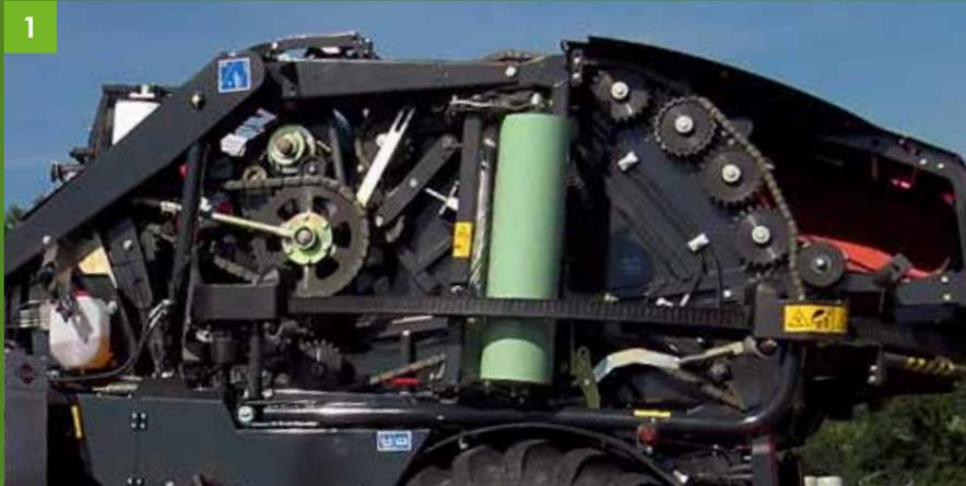
Trasmissione robusta tramite catene di alta qualità IWISv
