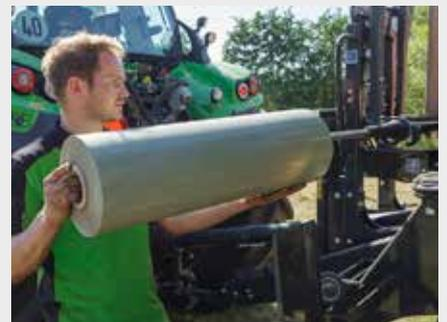
↑ Grazie al loro peso limitato (non oltre i 27 kg), le bobine sono facili da maneggiare. Questo, insieme all'altezza di sollevamento ridotta e al sistema di gestione intuitivo, rende estremamente facile la sostituzione delle bobine. Si può facilmente passare dalla pellicola alla rete e viceversa senza dover estrarre i rulli dalla macchina.
