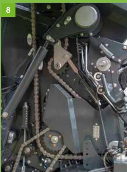
Trasmissione robusta con catene sovradimensionate e resistenti all'usura
