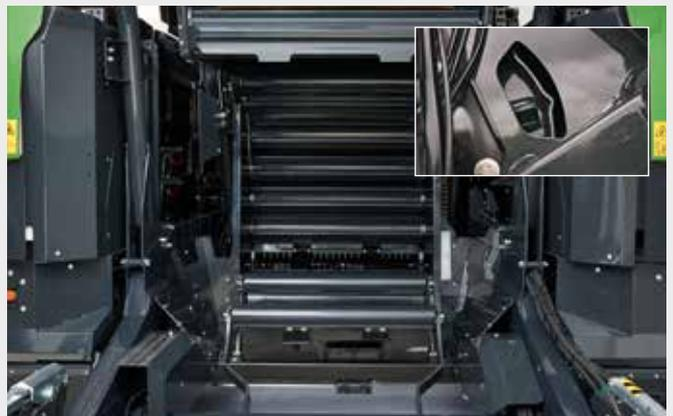
↑ Il cuore della pressa è costituito da 18 rulli POWERTRACK che generano densità eccezionalmente elevate e una rotazione affidabile delle balle in tutte le condizioni di raccolta. I rulli sono dotati di raschiatori incorporati per spingere il materiale fuori e lontano dai cuscinetti.
