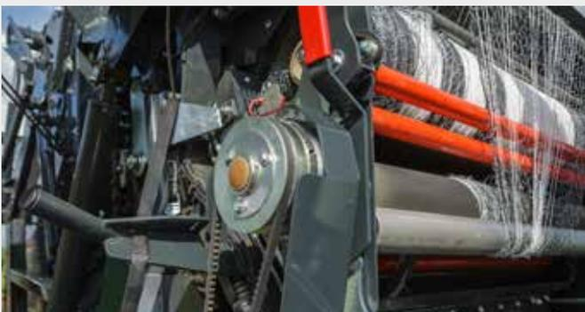
↑ L'innovativo design DEUTZ-FAHR mantiene costante la tensione della rete durante il processo di legatura. Il sistema di avvolgimento della rete gira a una velocità inferiore rispetto a quella di rotazione della palla, così da tendere la rete in maniera uniforme e fino al 10% in più, senza romperla. Grazie alla rete pre-tensionata, la palla manterrà la sua densità.
