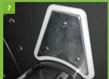
Il sistema i-DENSE adatta automaticamente la pressione di lavoro in base alle misurazioni elaborate dal sensore di umidità.
