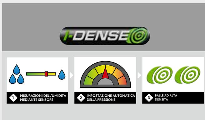
↑ Questo sistema adatta automaticamente la pressione di lavoro in base ai diversi prodotti e alle loro condizioni, senza l'intervento dell'operatore. Il sistema è costituito da un sensore di umidità combinato con un sistema intelligente a doppio bilancere per una distribuzione ottimale della tensione.
