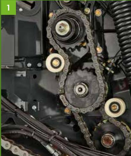
Il secondo rullo con azionamento a cinghia assicura un azionamento sicuro delle cinghie qualsiasi sia la condizione del foraggio.
