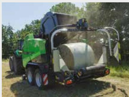
↑ I modelli VARIMASTER BALEPACK e FIXMASTER BALEPACK presentano una camera di pressatura specificamente adattata per evitare il danneggiamento della pellicola e garantire la legatura senza dover scendere a compromessi. I bracci caricatori sono dotati di speciali rulli lisci per evitare il danneggiamento della pellicola durante il trasferimento della bala.
