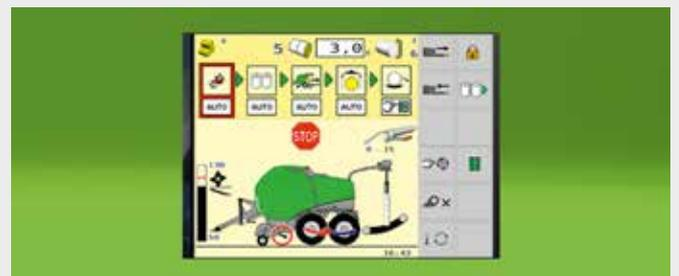
In caso di ingolfamento, il DROPFLOOR può essere abbassato e i coltelli retratti grazie al sistema di sblocco automatico del rotore. Dopo la ripartenza del rotore, il DROPFLOOR e i coltelli tornano automaticamente nella loro posizione di lavoro.
