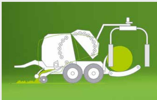
↑ Le piastre di protezione laterali delle guide garantiscono un trasferimento rapido e sicuro delle balle anche quando si lavora in campi sconnessi o con forti pendenze. Il sistema ottimizzato di carico a doppia forca aumenta la velocità di trasferimento della palla fino al 30%.
