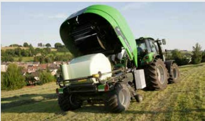
↑ La COMPACMASTER+ è dotata di un esclusivo anello di fasciatura, con due pre-tensionatori integrati. Questi ruotano attorno alla palla ad una velocità impressionante (fino a 50 giri/min). Per fasciare una palla con 6 strati di pellicola occorrono appena 18 secondi.
