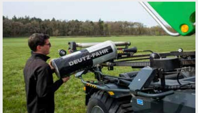
↑ Il pre-tensionatore ruota sopra l'anello di fasciatura per scambiare facilmente i rotoli di pellicola. Il rullo di supporto integrato previene il danneggiamento della pellicola e aiuta a sostenere il peso. Independentemente dalla tua altezza, è possibile cambiare i rotoli di pellicola senza sforzo.
