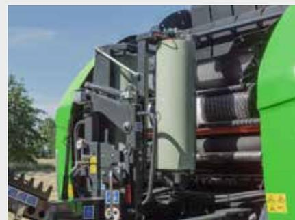
↑ I sistemi di legatura a pellicola e a rete sono separati, pertanto l'operatore può trasportare la pellicola e la rete allo stesso tempo. È possibile passare da un sistema all'altro in modo semplice e rapido - non c'è bisogno di cambiare i rulli né di utilizzare attrezzi particolari.
