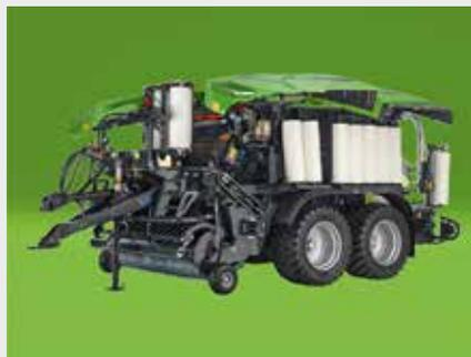
↑ Il sistema di legatura DEUTZ-FAHR utilizza gli stessi rotoli di pellicola utilizzati per la fasciatura. Questo elimina l'esigenza di ricorrere ad apposite bobine larghe, semplificando la gestione degli stock.
