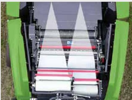
↑ La première partie du film assure un liage ferme et un démarrage fiable en toute circonstance, réduisant ainsi les temps d'arrêt au minimum. Très fin au départ, le film arrive très rapidement à atteindre toute la largeur de la balle. Autre facteur d'économies de film par rapport à un système à film large conventionnel !
