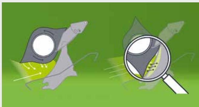
↑ Les rotors de coupe OPTICUT (OC) sont conçus pour une capacité d'alimentation sans restriction et une excellente qualité de coupe. Les rotors OC, avec leurs dents de rotor de forme elliptique, sont considérés par les utilisateurs comme l'un des meilleurs systèmes de coupe du marché. Le fourrage est précocement guidé vers les couteaux, ce qui améliore le flux et la performance de coupe, tout en nécessitant une puissance minimale. Cela évite également les blocages inutiles.
