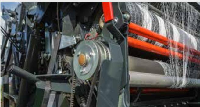
↑ Grâce à cette conception innovante de DEUTZ-FAHR, le filet est mis sous une tension constante pendant le cycle de liage. La vitesse du filet est inférieure à la vitesse de rotation de la balle. Le filet est ainsi étiré régulièrement jusqu'à 10 % sans courir le risque de casser. Grâce au filet pré-étiré, la balle va conserver sa densité.
