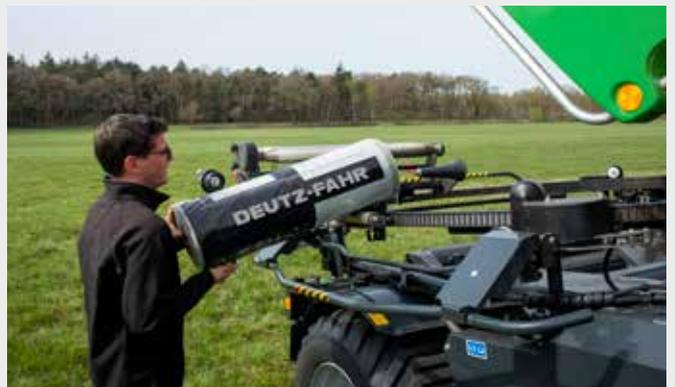
↑ Le pré-étireur pivote sur l'anneau d'enrubannage afin de pouvoir changer facilement les rouleaux de film. Le rouleau de support intégré évite d'endommager le film et aide à supporter le poids. Quelle que soit votre taille, vous pouvez changer les rouleaux de film sans effort.
