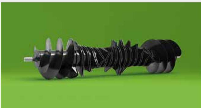
↑ Le ROTOR INTÉGRAL, doté du système OPTICUT à 14 couteaux, égalise l'andain pour une alimentation forcée du produit dans la presse et un rendement maximal. Le système OPTICUT à 14 couteaux assure une longueur de coupe théorique de 70 mm. Chaque couteau est protégé contre les corps étrangers par une sécurité individuelle par ressort. Le barillet rotatif offre la possibilité de choisir entre 0, 4, 7, 7 ou 14 couteaux.
