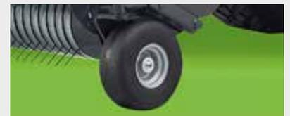
Roues de jauge pivotantes semi-pneumatiques
