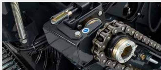
↑ Dans des conditions extrêmes, une double sécurité est offerte par un système de débrayage du rotor standard. Cela permet d'assurer le liage et le déchargement de la balle dans la chambre avant la poursuite des opérations.
