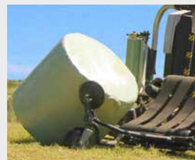
Dépose balle vertical
