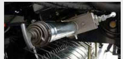
Système de graissage des roulements BEKA-MAX
