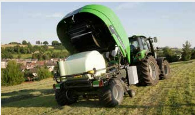
↑ L'anneau d'enrubannage, avec deux pré-étireurs intégrés, est une caractéristique unique de la COMPACMASTER+. Ils tournent près de la balle à très grande vitesse (jusqu'à 50 tr/min). 18 secondes à peine sont nécessaires pour enrubanner une balle avec 6 couches de film.
