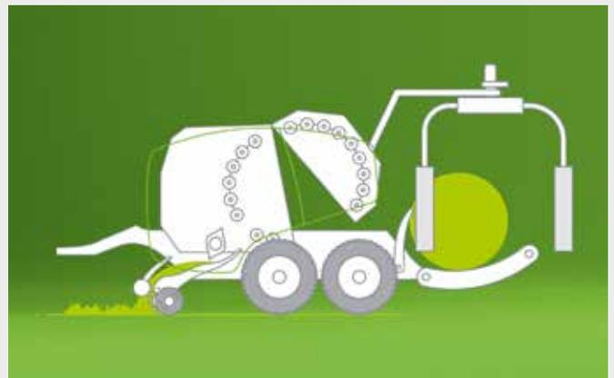
↑ Les tôles de guidage latérales assurent un transfert rapide et fiable de la balle même sur les parcelles très pentues. Le système à « double bras de transfert » assure un transfert jusqu'à 30 % plus rapide de la balle sur la table d'enrubannage.
