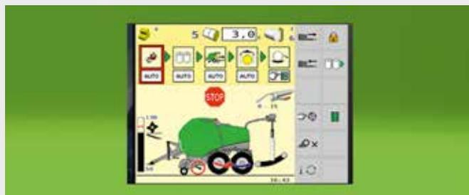
↑ L'abaissement du DROPFLOOR et la rétraction des couteaux peuvent être exécutés automatiquement en cas de blocage du rotor, grâce au système de déblocage automatique du rotor. Après le redémarrage du rotor, la trappe escamotable DROPFLOOR ainsi que les couteaux reviennent automatiquement en position initiale.
