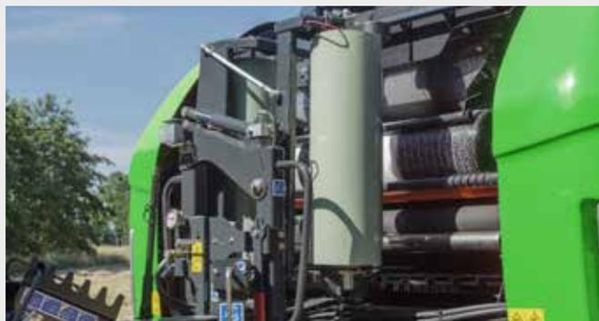
↑ Pour l'enrubannage, le système de liage Filet + Film est la meilleure option. En liant la balle avec du film, les couches supplémentaires de film scellent la balle de manière étanche, assurant ainsi une meilleure conservation et une stabilité de la forme. En outre, le liage par film offre plusieurs avantages en termes d'efficacité.
