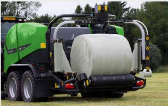
↑ Les ingrédients clés d'une balle parfaite sont une forme optimale et une densité élevée. L'association du ROTOR INTEGRAL et de la conception unique de la chambre de pressage permet d'obtenir une forme de balle parfaite avec un remplissage optimal de la balle d'un côté à l'autre.
