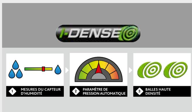
↑ Le système i-DENSE adapte automatiquement la pression de pressage en fonction des différentes cultures et des conditions de récolte, sans intervention du chauffeur. Le système se compose d'un capteur d'humidité associé à un système intelligent de bras à double tension pour une répartition optimale de la tension.
