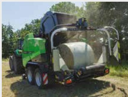
↑ Les VARIMASTER BALEPACK et FIXMASTER BALEPACK sont équipés d'une chambre de pressage spécialement adaptée afin d'éviter d'endommager le film et d'assurer un liage de qualité. Les bras de chargement sont équipés de rouleaux doux spéciaux pour éviter d'endommager le film pendant le transfert de la balle.
