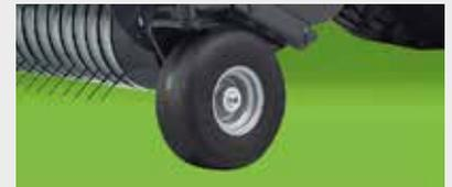
Roues de jauge pivotantes semi-pneumatiques
