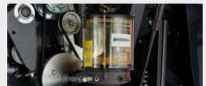
Graissage automatique avec réservoir 4 kg
