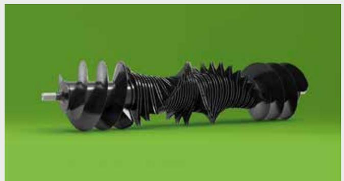
↑ Le ROTOR INTÉGRAL, doté du système OPTICUT à 23 couteaux, assure une coupe intensive et une protection mécanique. Ce système permet d'atteindre une longueur théorique de 45 mm. Chaque couteau est protégé contre les corps étrangers par une sécurité individuelle par ressort. Le barillet rotatif offre la possibilité de choisir entre 0, 7, 11, 12 ou 23 couteaux.
