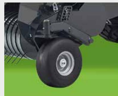
Roues de jauge pivotantes semi-pneumatiques
