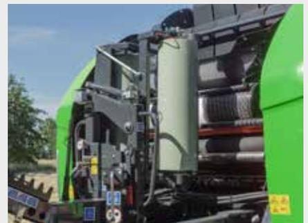
↑ Les systèmes de liage par film et par filet sont séparés. Basculer entre les deux modes de liage est rapide et simple : il n'est pas nécessaire de changer les rouleaux et aucun outil n'est requis.
