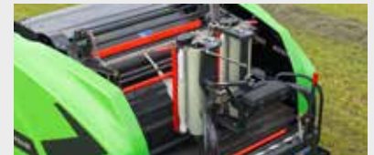
Atado con dos bobinas de plástico TWIN
