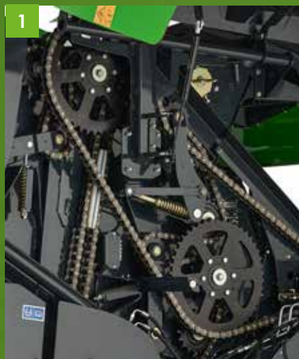
Transmisión robusta con cadenas IWIS de alta calidad
