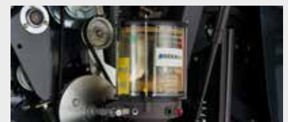
Engrase automático con depósito de 4 kg
