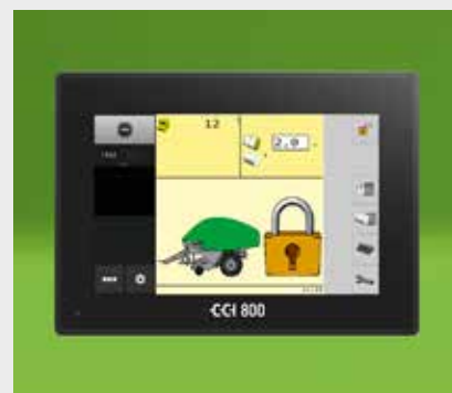
↑ CCI 800: El terminal ISOBUS compacto La pantalla de 8 pulgadas/20,3 cm permite visualizar la máquina principal y vistas en miniatura en el lateral. Haz clic en la vista en miniatura para mostrarla en grande.
