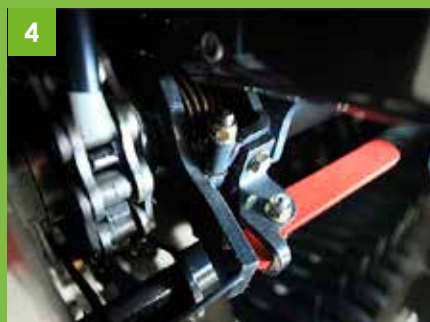
Desembrague mecánico del rotor
