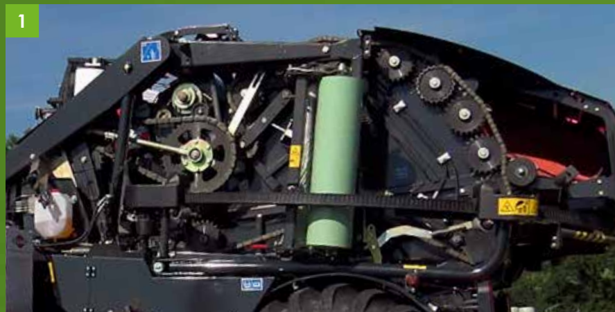
Transmisión robusta con cadenas IWIS de alta calidad
