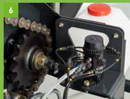
Sistema continuo de lubricación de cadenas BEKA-MAX
