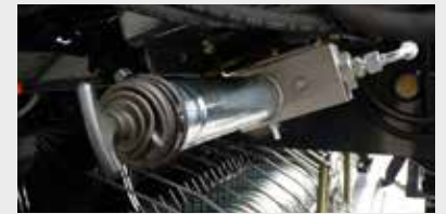
Sistema de lubricación de rodamientos automático BEKA-MAX
