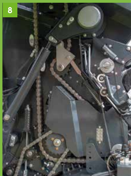
Transmisión robusta con cadenas resistentes al desgaste y de grandes dimensiones
