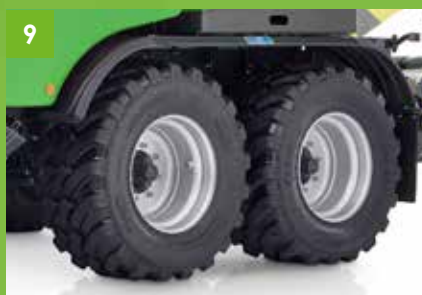
Eje tandem con ruedas 500/60R22.5
