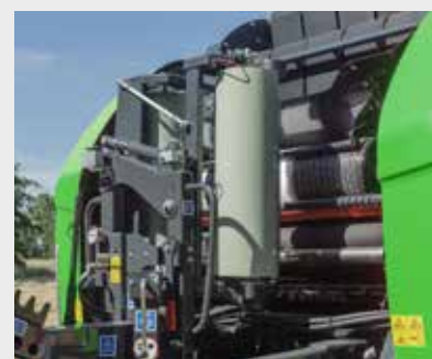
Atado con dos bobinas de plástico TWIN
