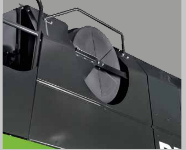
Soğutma sisteminin maksimum verimliliğini sağlayan büyük döner elek.
