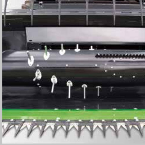
Tüm uzunluk boyunca geri çekilebilir besleme helezonu, sürekli besleme ve mahsul akışı sağlar.
