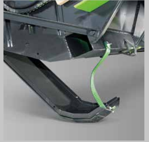
Autokontrol sistemi için güvenilir ve sağlam sensör plakalı.
