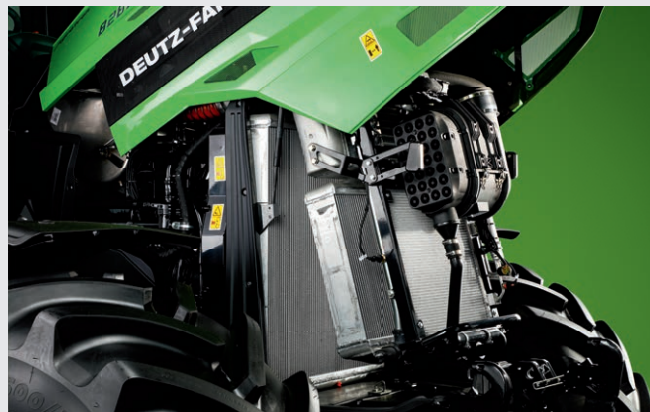
↑ Facile accesso a radiatore e filtro aria.
