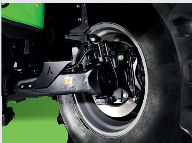
↑ Dischi freni a secco per massime prestazioni di frenata.
