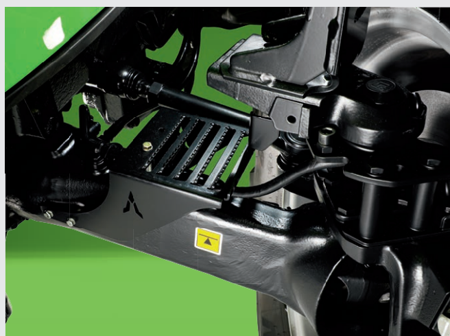
↑ Gradini per manutenzione sopra l'assale anteriore per un'agevole pulizia.
