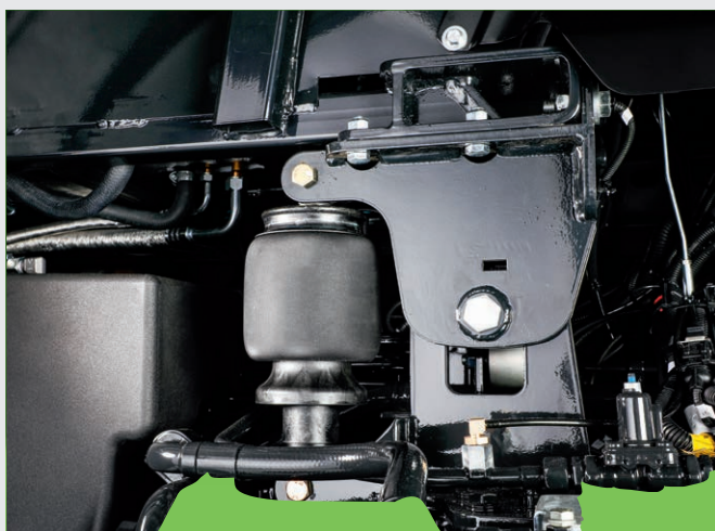
↑ Sospensione pneumatica della cabina per una guida più regolare.
