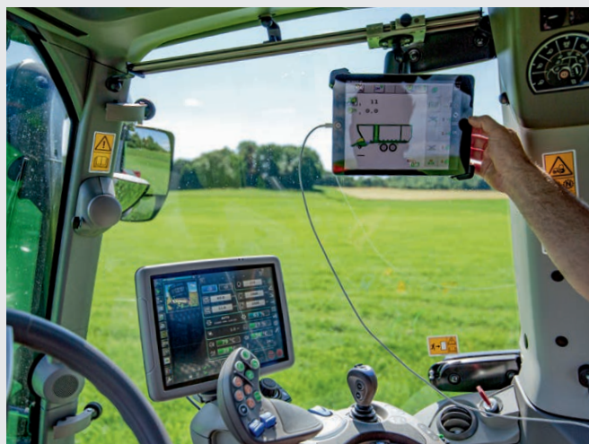
↑ Disponibile guida di fissaggio per monitor esterni.
