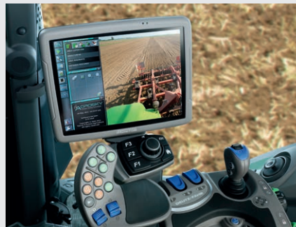
↑ Telecamera integrata con modalità a pieno schermo automatica (in retromarcia) per una chiara visuale e per motivi di sicurezza.
