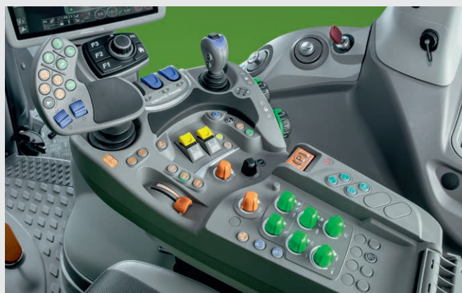
↑ Collaudata disposizione DEUTZ-FAHR. Funzioni raggruppate per colore per un utilizzo intuitivo.
