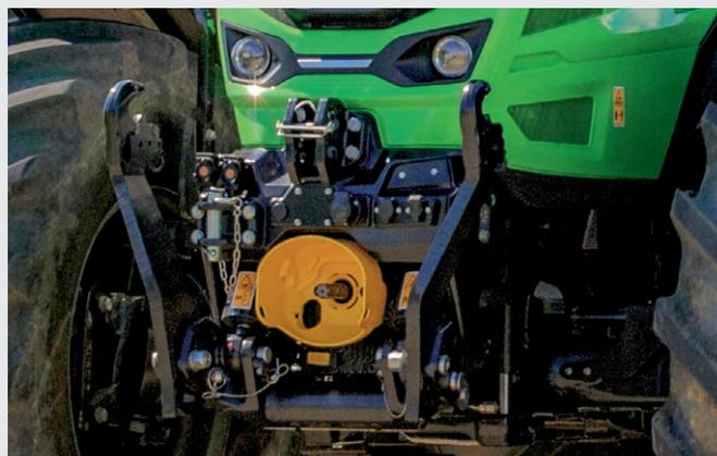
↑ Capacidad de elevación de 5450 kg y TDF delantera de doble velocidad.
