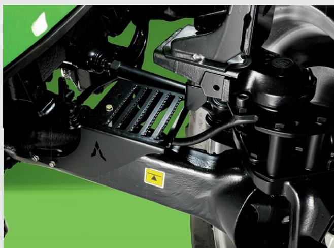
↑ Estribos de mantenimiento encima del eje delantero para una limpieza cómoda.
