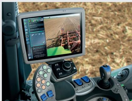
↑ Cámara integrada con modo automático de pantalla completa (p. ej., marcha atrás) para una mejor visibilidad y seguridad.
