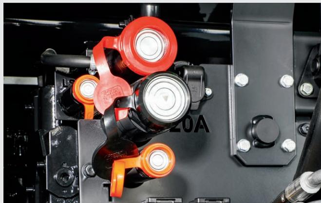
↑ Acopladores de cara plana para una conexión limpia.
