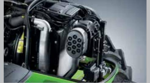
Radiateur compact avec ventilateur à viscocoupleur et filtre à air PowerCore pour une efficacité maximale du moteur.
