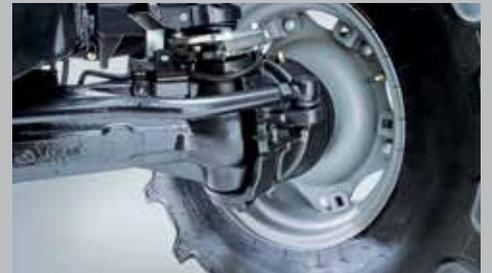
Quatre roues motrices à activation électronique et blocage différentiel à 100 %, freinage sur les quatre roues et angle de braquage de 55 degrés.
