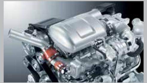
Moteurs FARMotion à rampe commune d'injection électronique à 2 000 bar, recirculation des gaz d'échappement et système DOC.
