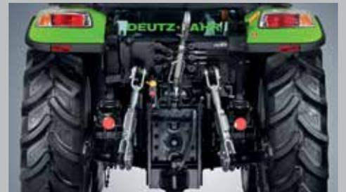
Pompe hydraulique de 50 l/min, jusqu'à trois distributeurs de commande, relevage arrière d'une capacité de levage de 3 500 kg, PDF 540/540ECO/1000.
