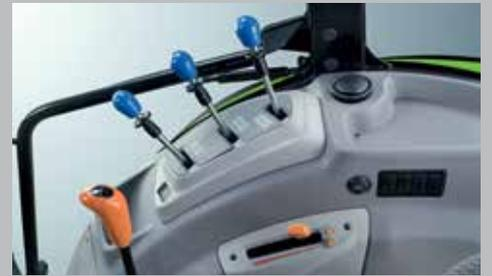
Transmission mécanique avec un maximum de 30 + 15 rapports, 40 km/h à 1 870 tr/min.
