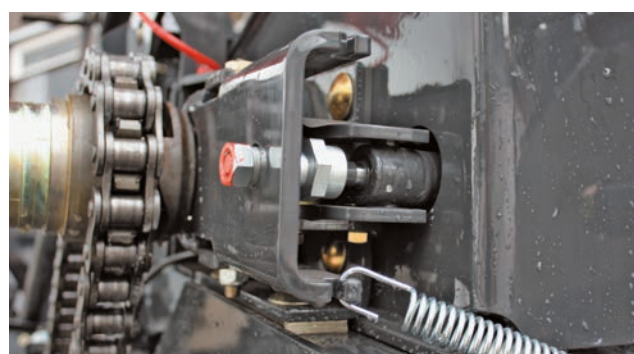
DÉSENGAGEMENT HYDRAULIQUE DU ROTOR
