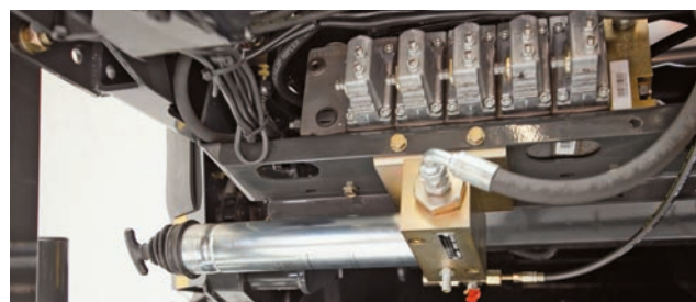
GRAISSAGE AUTOMATIQUE DES ROULEMENTS DES ROULEAUX
