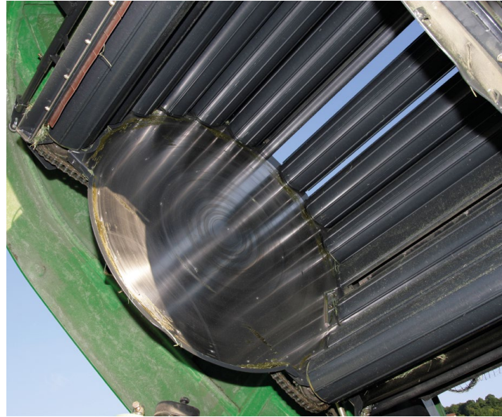
REIBUNGSSARME PLATTEN AUS ROSTFREIEM EDELSTAHL
