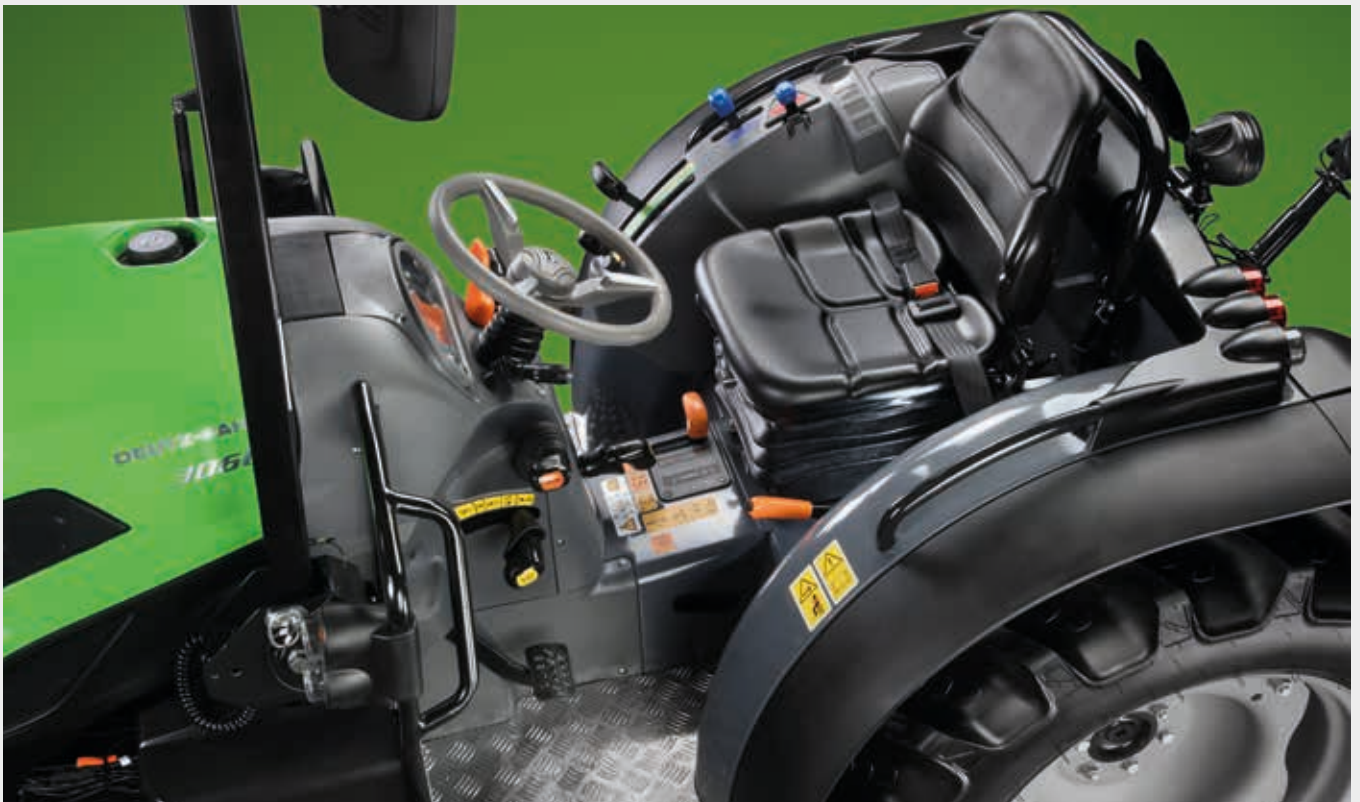
↑ Rolbeugluitvoering met platform met vering op Silent-Blocks.
