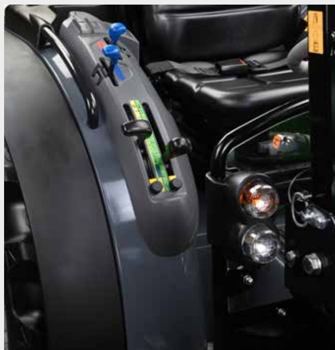
↑ Hefinrichting achter met trekkracht-, positie- en mengregeling.
