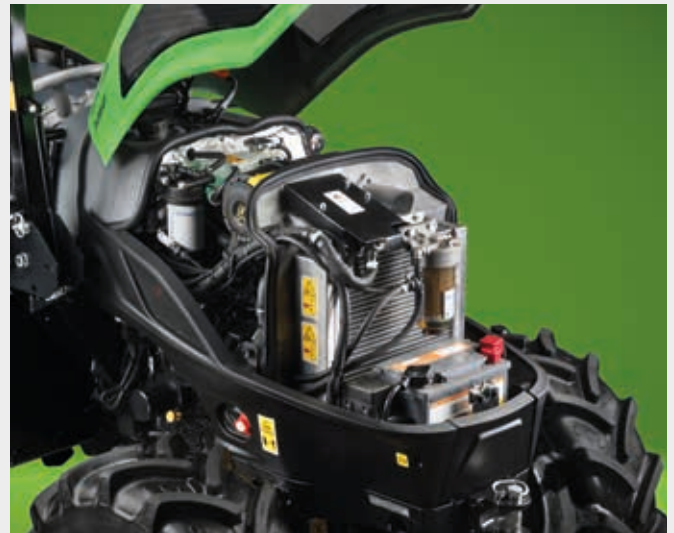
⬆ Stage V-conforme motoren met common rail-inspuiting en een vermogen tot 59 pk.
