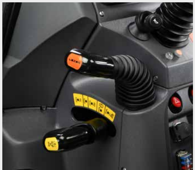
↑ Mechanische transmissie met gesynchroniseerde omkeerinrichting.
