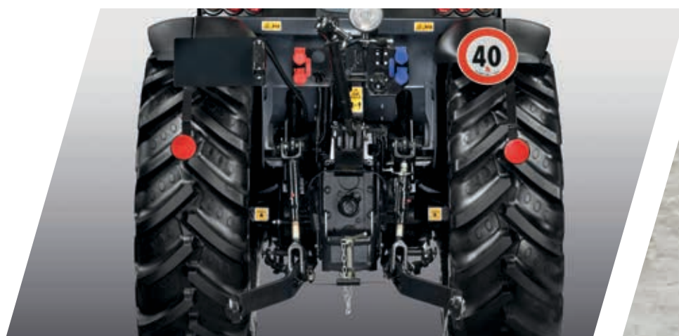
> WOM z 3 prędkościami oraz zsynchronizowany z prędkością jazdy do wszystkich zastosowań.
