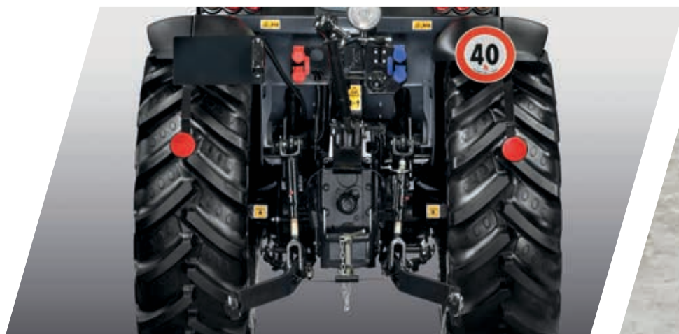
> TDF de 3 velocidades e TDF proporcional ao avanço para atender a qualquer aplicação.
