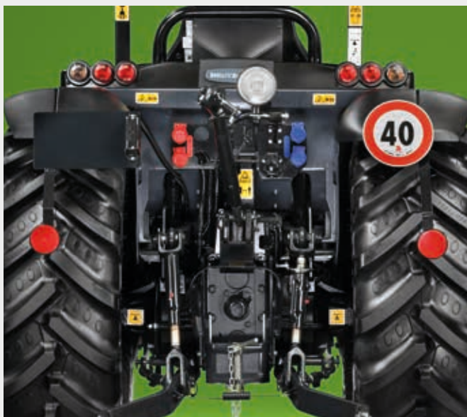
↑ TDF de 3 velocidades e TDF proporcional ao avanço para atender a qualquer aplicação.
