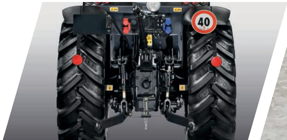
> 2 Zapfwellenkonfigurationen und Wegzapfwelle für jeden Einsatzzweck.
