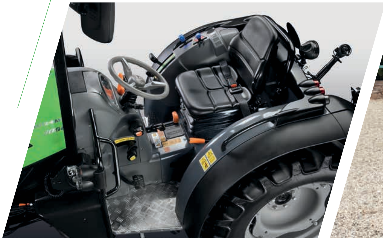
> Offene Fahrerplattform auf Silent-Blöcken gelagert, mit klappbarem Überrollbügel.
