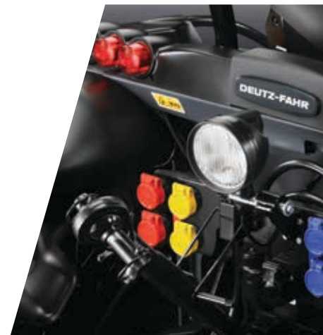
> Bis zu 6 Hydraulikanschlüsse im Heck.
