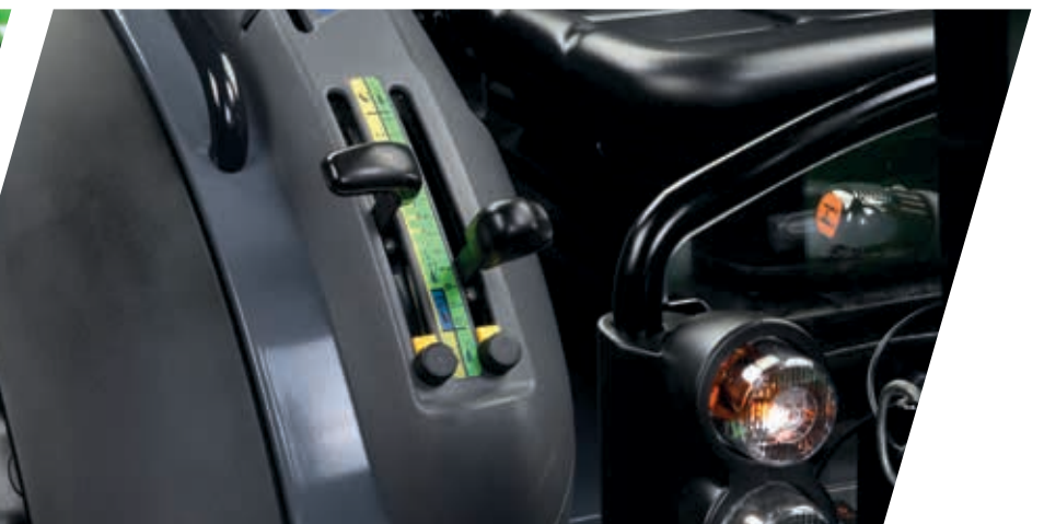
> Heckkraftheber mit Zug-, Lage- und Mischregelung.
