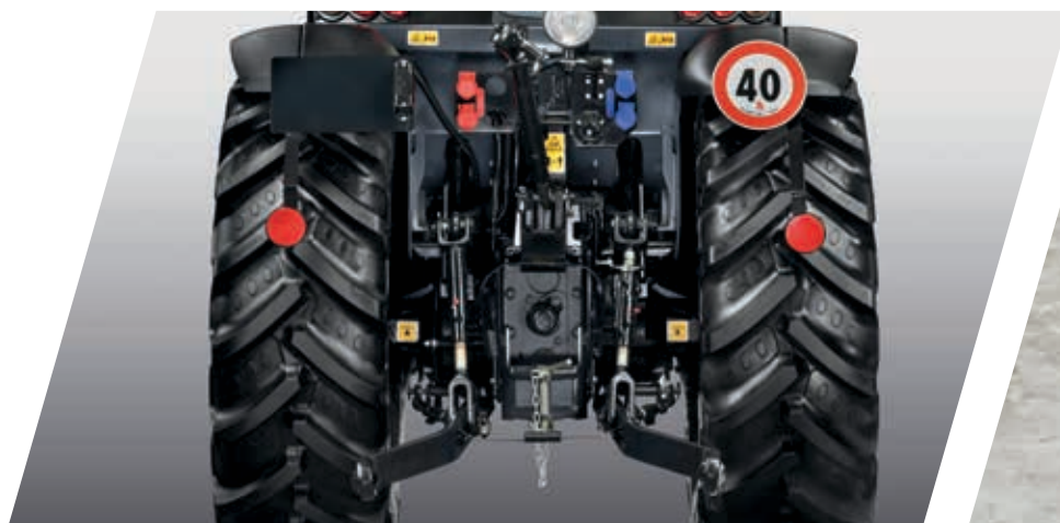
> TDF de 3 velocidades y TDF sincronizada para adaptarse a cualquier aplicación.
