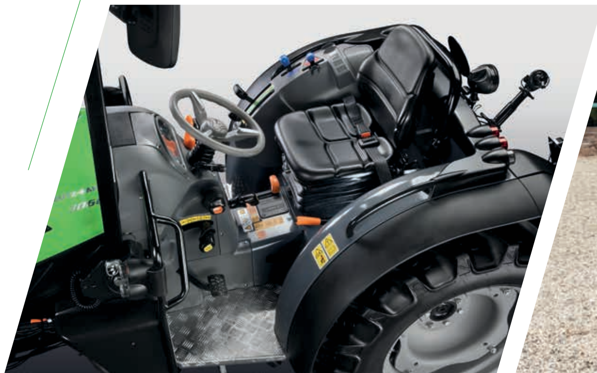
> Versión ROPS con plataforma suspendida sobre casquillos elásticos Silent-Block.
