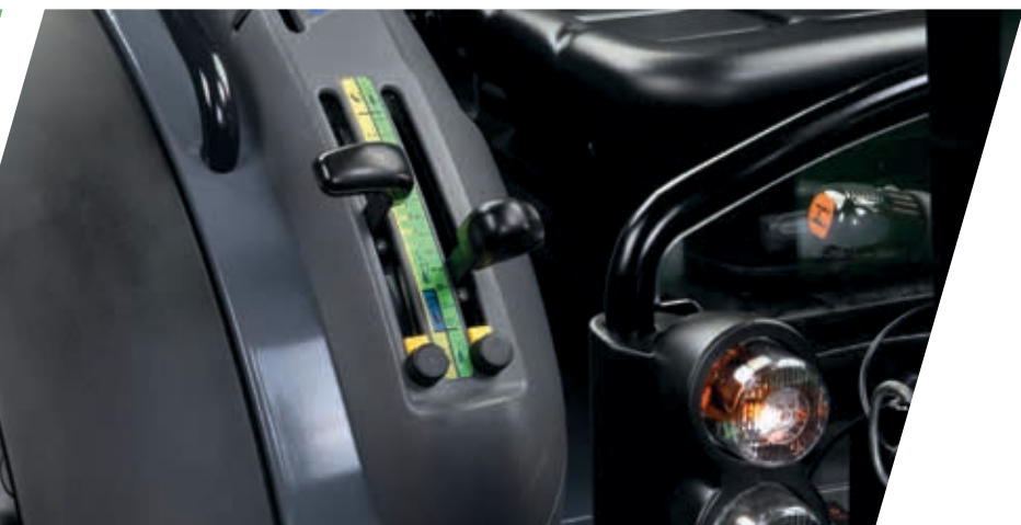
> Elevador trasero con control de esfuerzo, de posición y mixto.
