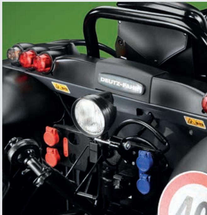
↑ Hasta 6 vías hidráulicas traseras.
